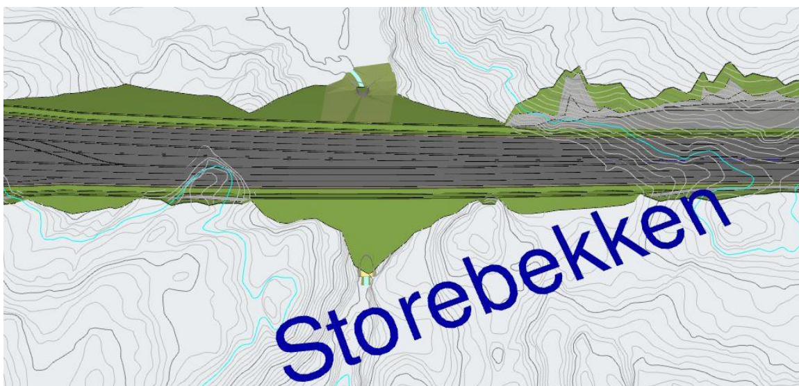
Figur 2.1.4.1: Storebekken kulvert – bekken krysser under fylling for ny E39.
