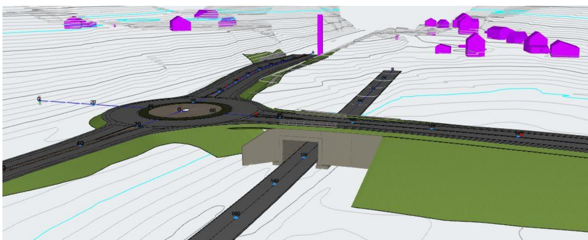
Figur 4.1.1.1: Utland kulvert fører tilførselsveien over Vestbygda. Sett mot vest. Utland i bakgrunnen.
