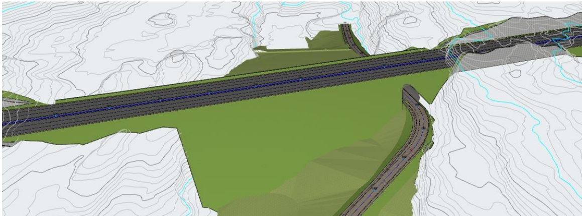
Figur 2.1.12.1: Breiheia kulvert – skogsbilvei føres i en kulvert gjennom veifyllingen for ny E39. Sett mot nordøst.
