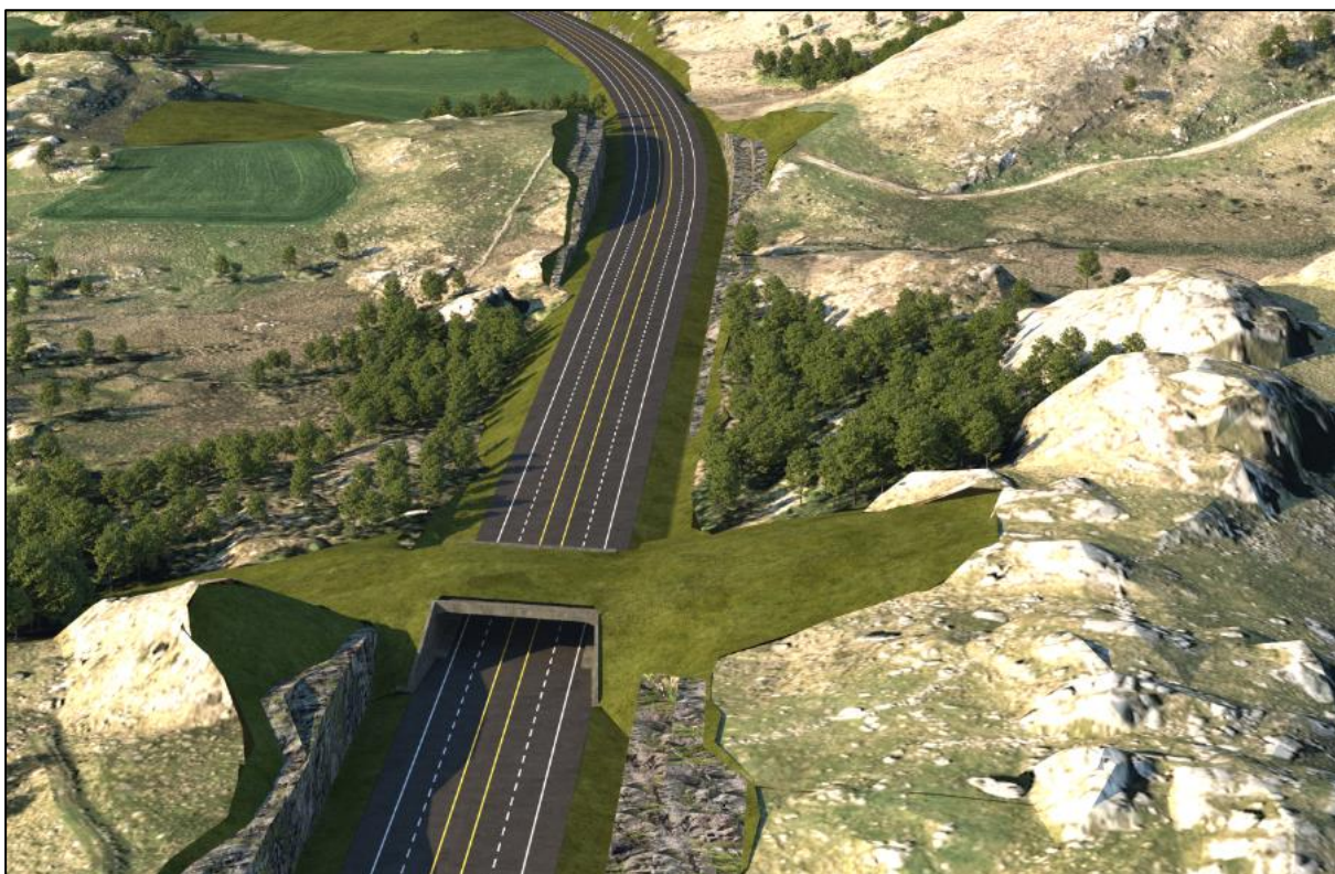
Figur 4-1: Strekning B. Faunapassasjen som er vist i illustrasjonen over er prinsipielt utformet og endelig plassering avklares innenfor et større område slik det framkommer i plankart.
