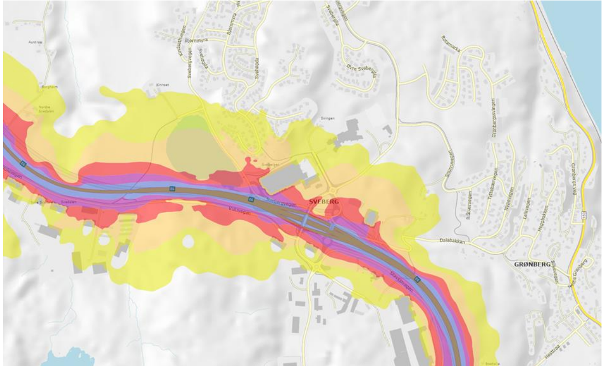
Figur 5-17 Støysoner ved Sveberg for eksisterende situasjon, hentet fra Statens vegvesens støysoner for riks- og fylkesveier
