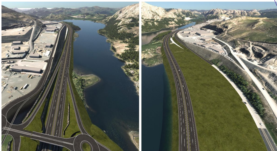
Figur 6-24: Venstre: Veien i nordgående retning langs Klugsvatnet ved Skurve. Høyre: Fra nordenden av Klugsvatnet retning sørover. Fra Måganeset er veien planlagt på fylling i vann og det er foreslått å legge til rette for nytt jordbruksareal mellom ny og gammel vei.
