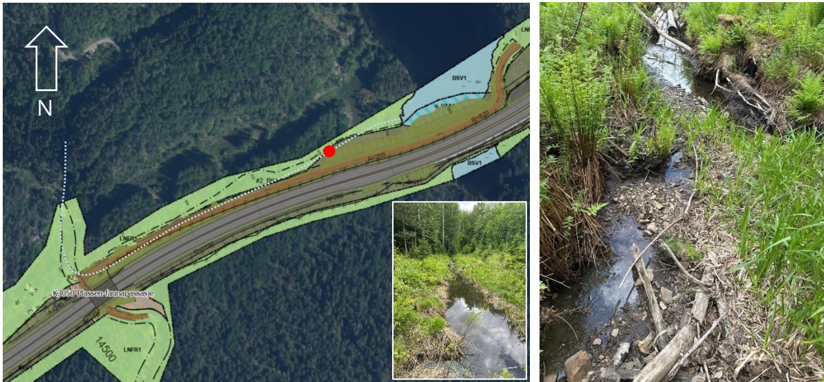
Figur 6-18: Liten bekk renner langs dagens E18 forbi gården Plassen til utløp i Skaugtjenna mot øst. Rødt punkt viser vandringshinder (for bratt). Høyre bilde viser at nedre deler av bekken har grusholdig substrat. Minibilde tyder på at bekken er kanalisert ut mot Skaugtjenna (Sweco Norge).
