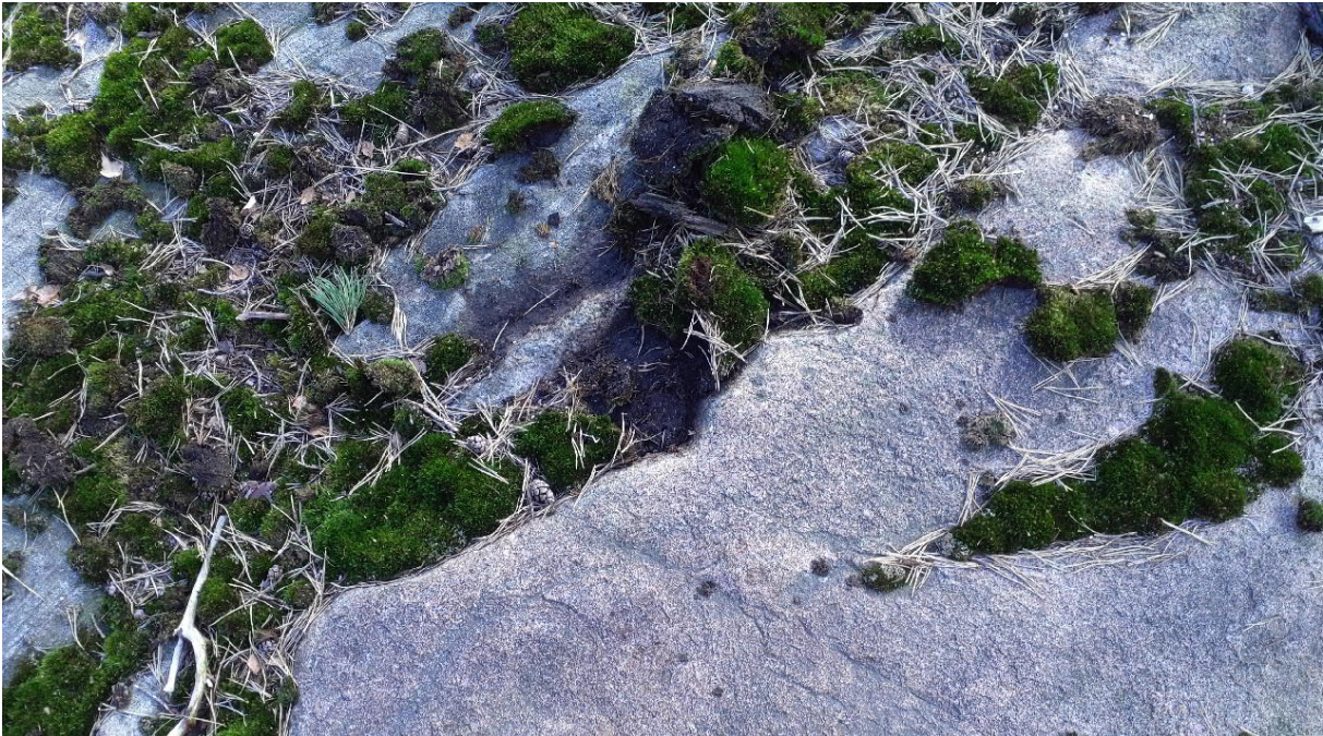
Figur 12: Lokal variasjon i bergmasse. Finkornet granitt nede til høyre, båndgneis oppe til venstre i bildet. Bilde ved ca. pel 7185.
