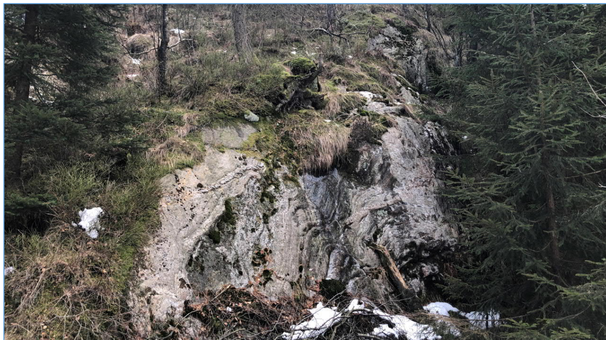
Figur 11: Bergblotning ved ca. pel 6880 med foldet båndgneis. Sideberg til svakhetssone 6.
