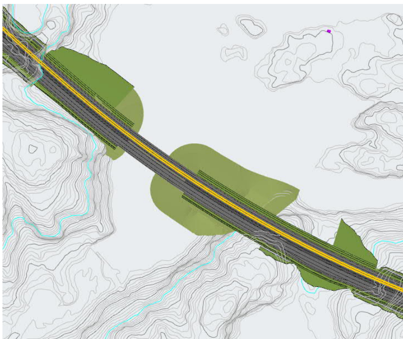
Figur 17 Fyllinger ved Grundelandsvatnet bro (Sweco, 2021)
