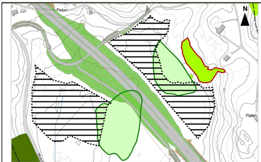
Figur 4. Viser permanent masselager på Flaten (skraverte områder). Viktig naturtype (rødt omriss) i nord berøres ikke. Lokalt viktige naturtyper (grønt omriss) blir delvis berørt av det permanente masselageret og veiltiltaket.
