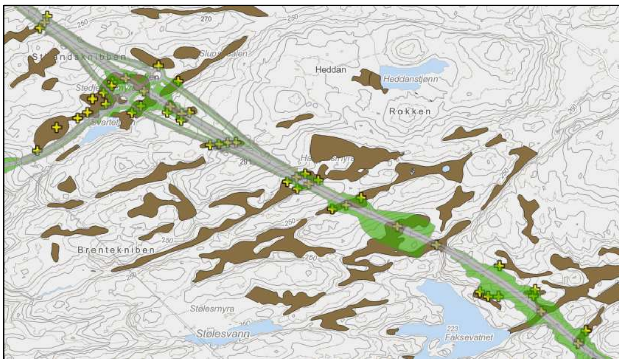
Figur 8.1 områdene vest for Audnedalen er det mye myr og flere av dem har hovedutstrekning på tvers av linja. Gule kryss viser hvor det er utført dybdemålinger av myr.
