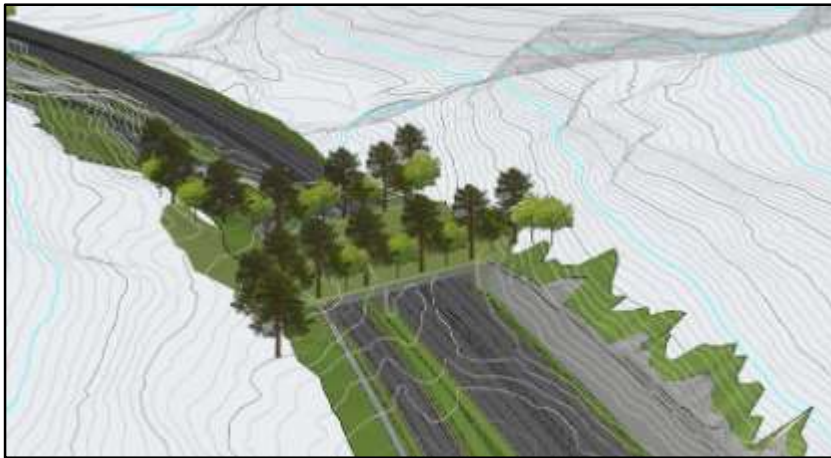
Figur 6. Faunapassasje Optedal, Lyngdal kommune. Krysser både eks.vei og ny vei. Kilde: Fagrapport konstruksjon.
