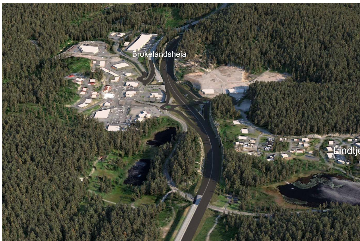
Figur 6-24 Nytt kryssområde ved Brokelandsheia oversikt. Skjæringer vist med grå flate, fyllinger med grønt. (Cowi AS, 2021)
