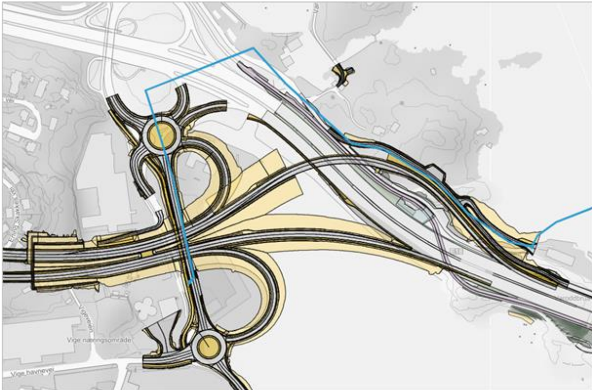
Figur 5-2. Figur viser ny trasé for VA (blå) med ilandføring fra Topdalsfjorden og landtrasé.
