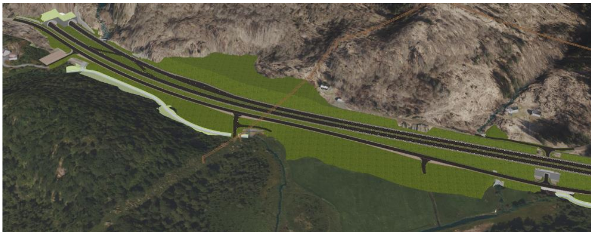
Figur 4-12: Fidjeland til Vatlandstunnelen. Utslaking av veifylling på Steggan, masselager/voll og omlagt bekk langs ny trasé for Dragedalen.
