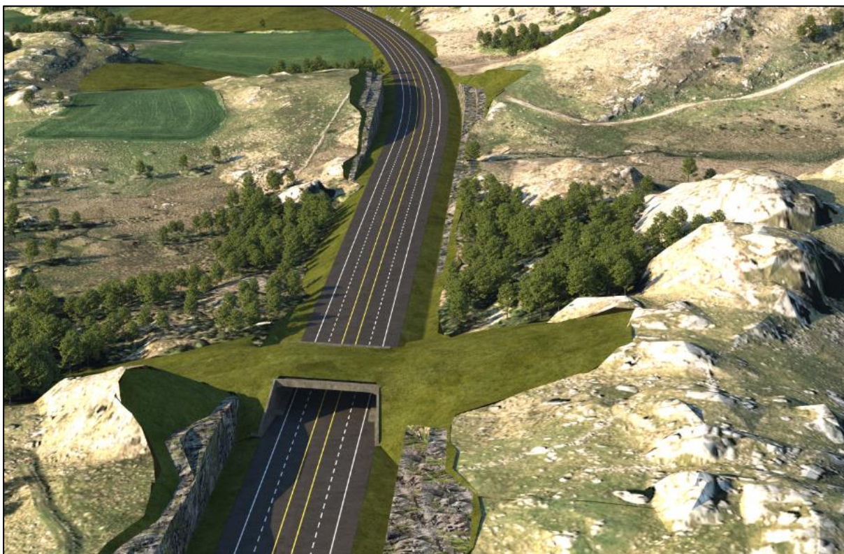
Figur 6-11: Faunapassasjen som er vist i illustrasjonen over er prinsipielt utformet og endelig plassering avklares innenfor et større område slik det framkommer i plankart.
