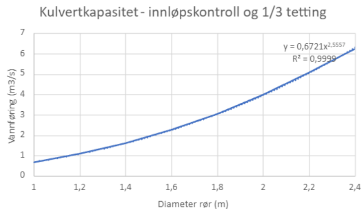
Figur 3-1: Resultater fra analyse av kulvertkapasitet for sirkulære rør med 1/3 gjentetting av rørets høyde i HY-8.
