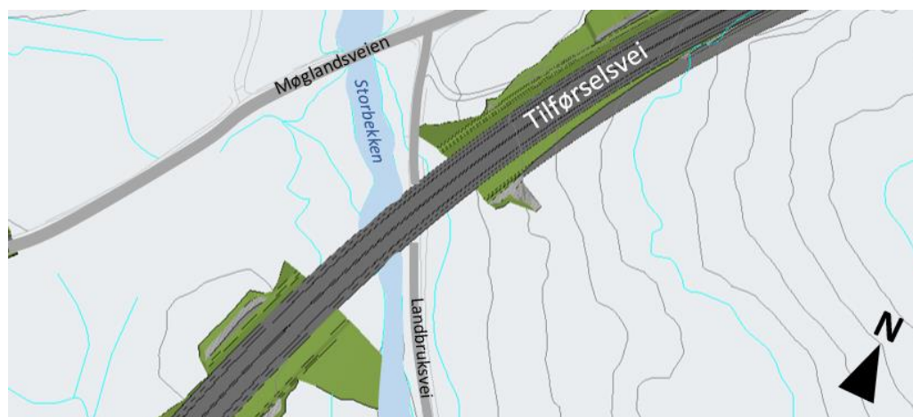
Figur 3-31: Viser tilførselsveien krysse Storbekken og eksisterende landbruksvei på bru. (Kilde: Sweco Norge)
