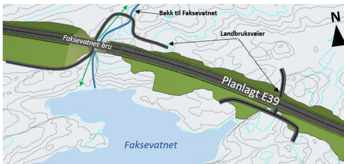
Figur 3-24: Viser tiltakene ved Faksevatnet, med angivelse av hvor viltet beveger seg under brua (grønn pil). (Kilde: Sweco Norge)
