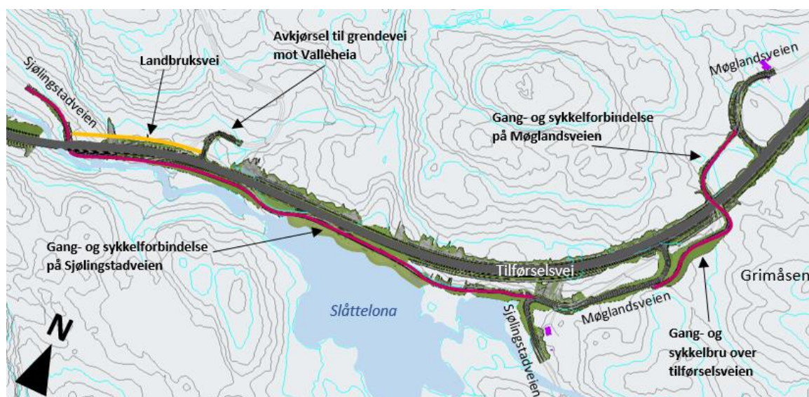
Figur 3-32: Viser tilrettelegging for gang- og sykkelveier (røde linjer) på eksisterende veier, og omlegging av eksisterende veier mot tilførselsveien. (Kilde: Sweco Norge)
