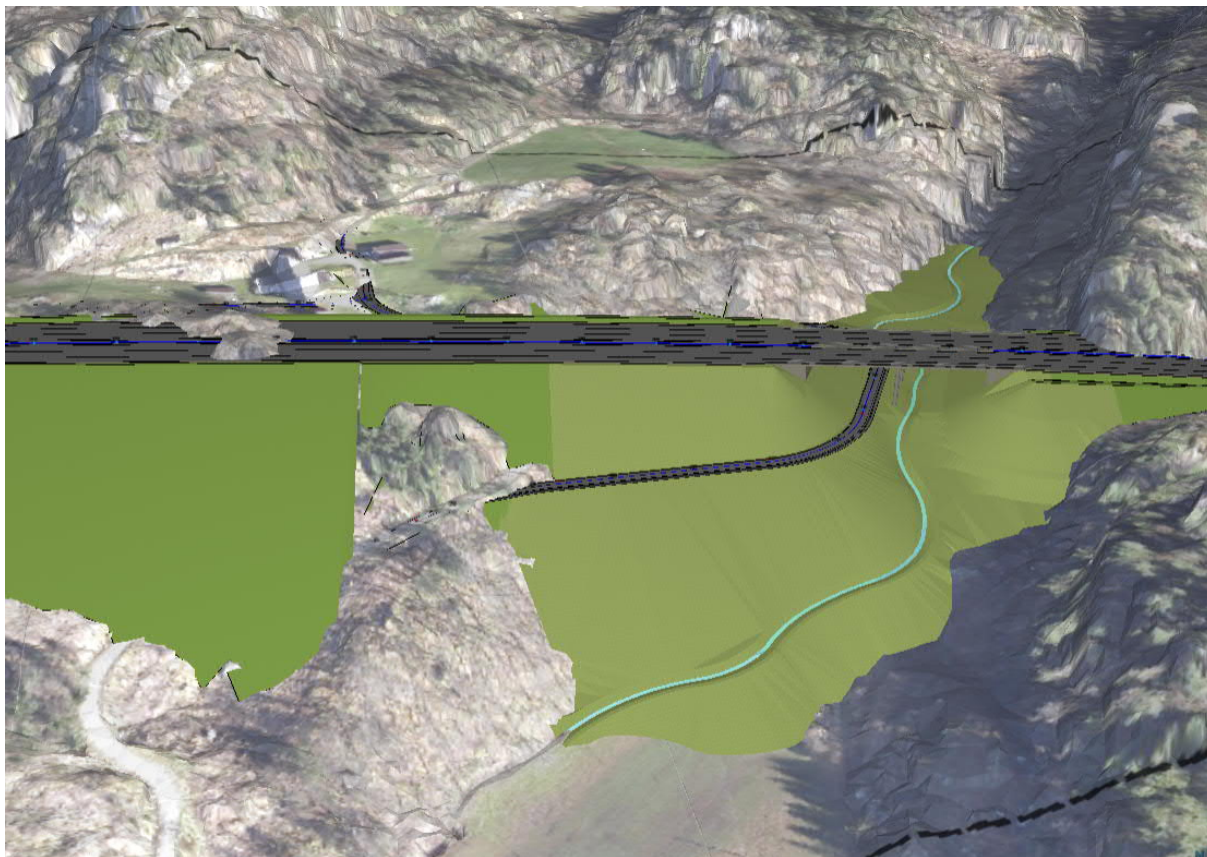
Figur 15. Ny bru over Djubedalen, og omlegging av Haddelandsveien under brua.
