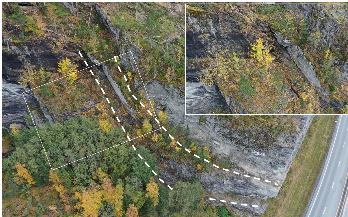
Figur 26: Dronebilde av svakhetszone 1 ved profilnummer 16180.
