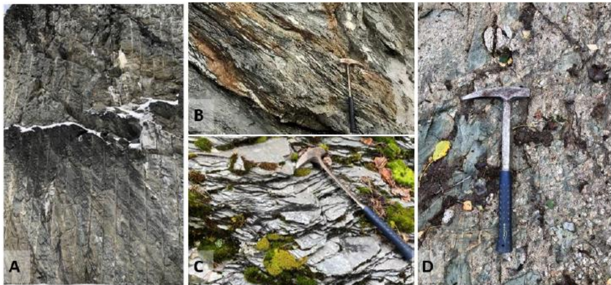
Figur 10: A: Gråvakke i overgang til fyllitt/skifer. B: Sone med forvitret fyllitt/skifer i massiv gråvakke. C: Skifer med høy grad av skifrihet. D: Polymikt konglomerat observert 100 meter øst for eksisterende bergskjæring.
