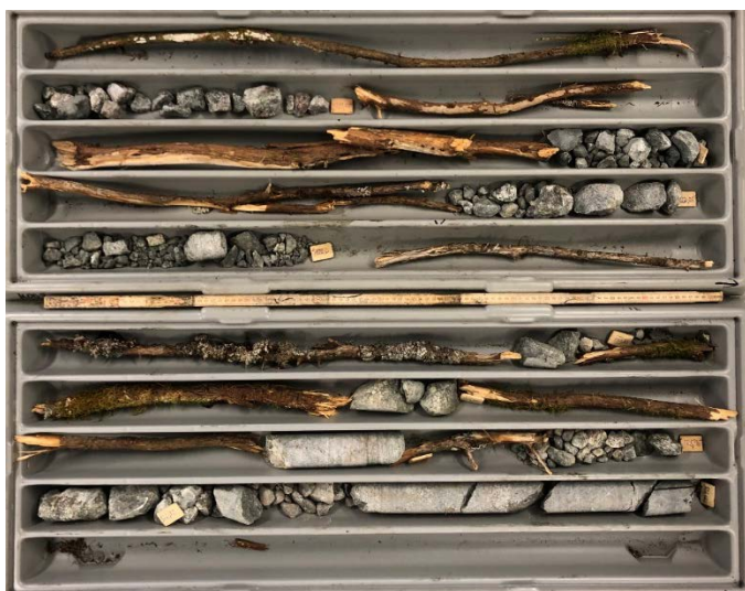
Figur 6-6: K001, bilde av de siste to kassene. Stort kjernetap og knust kjerne. Bildet er hentet fra [18].
