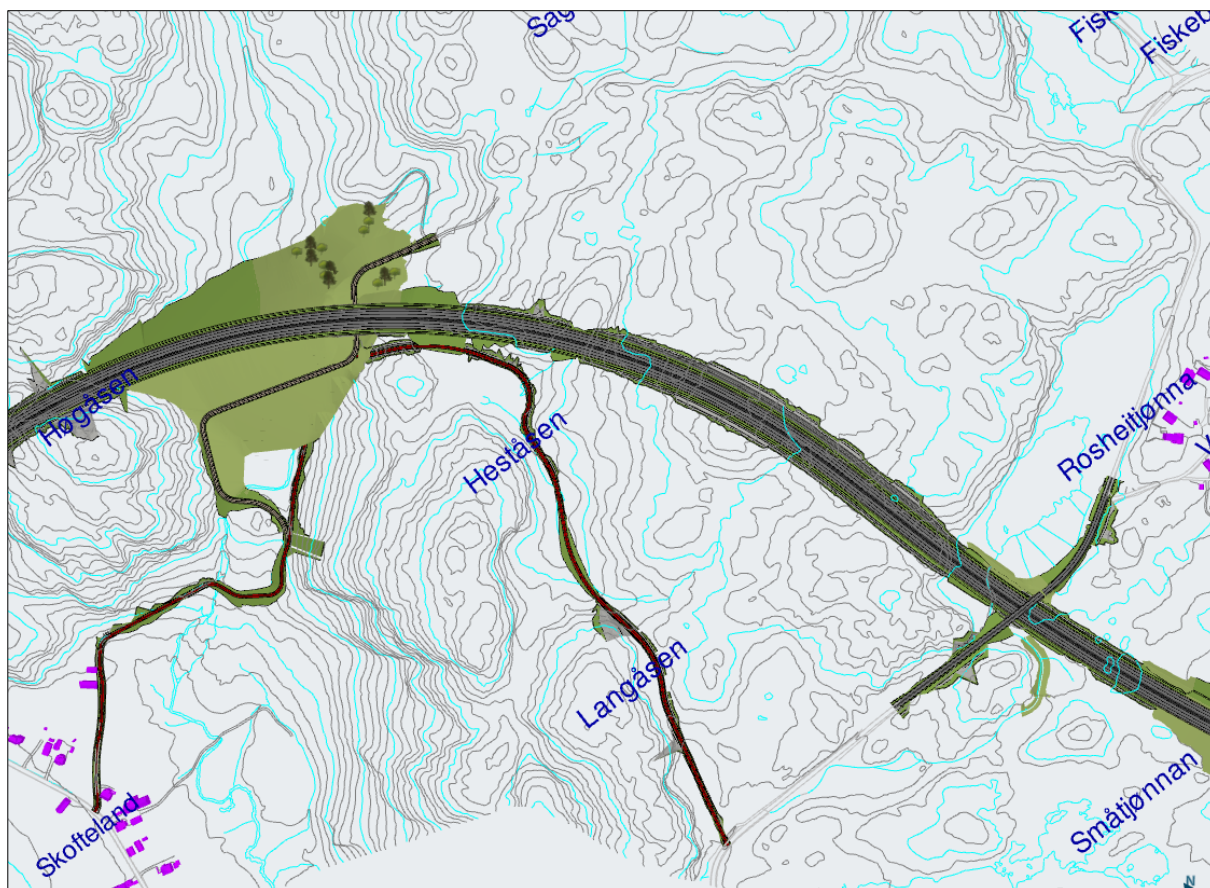
Figur 3-11 viser omalgt Kårstølveien over E39 (høyre), og traktorvei i Skoftedalen (venstre). I tillegg vises to foreslåtte anleggsveier
