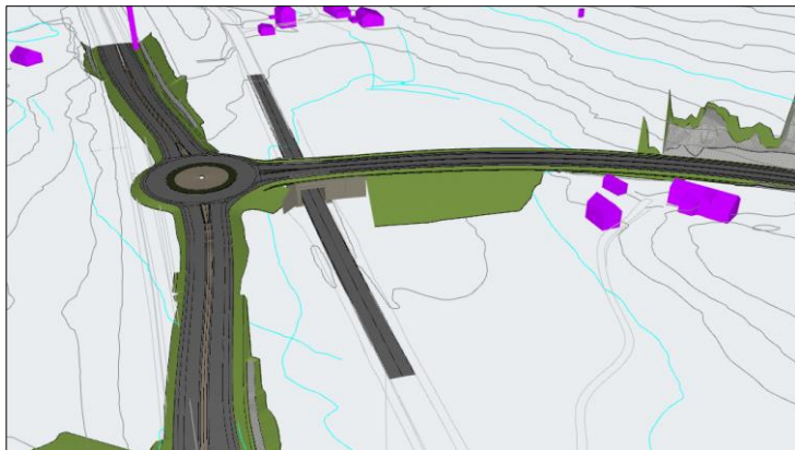
Figur 3-22 viser Vestbygda i kulvert under ny tilførselsvei
