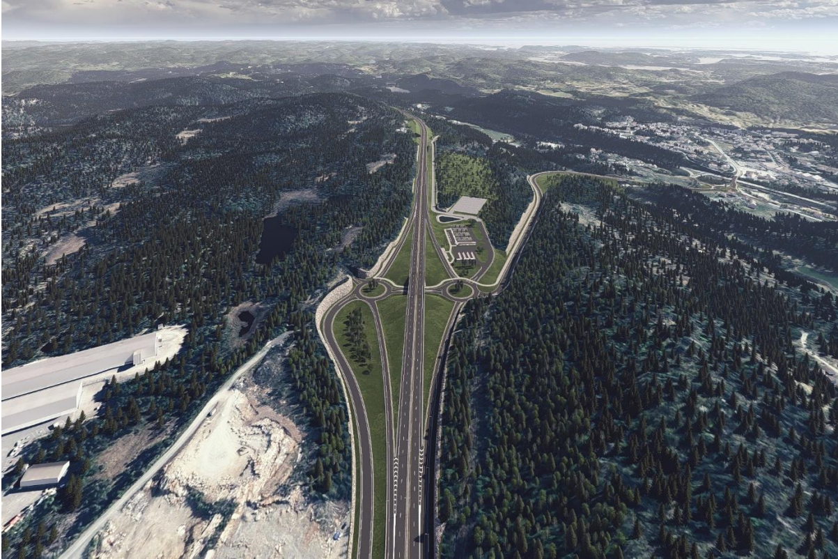
Figur 7-1: Ved Fikkjebakke er nytt kryssområde plassert med forankring i overordnede terrengformer, eksisterende næringsområde og lokalveistrukturer. Gode tverrforbindelser for lokal biltrafikk og gang-sykeltrafikk er innarbeidet i løsningen. (Kilde: Sweco)
