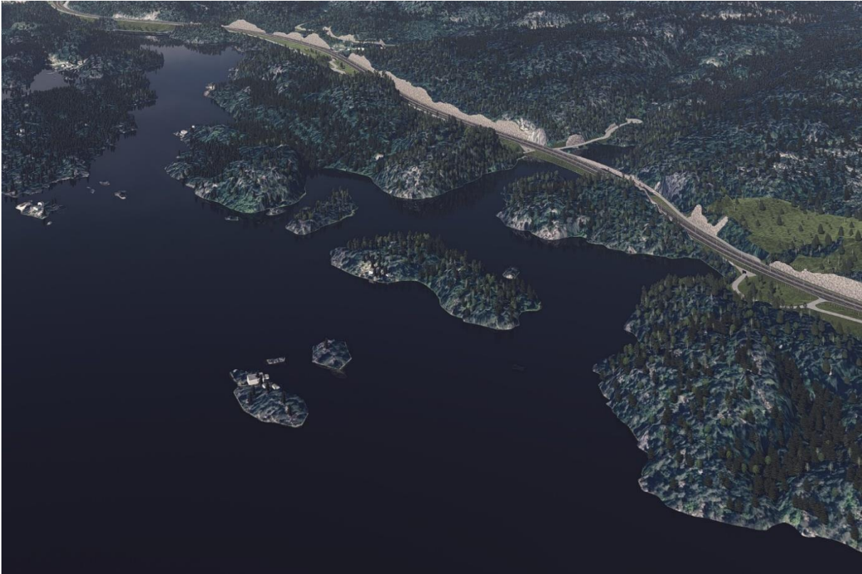
Figur 6-2: Planlagt E18 langs Hullvann. Hullvann er vurdert å ha stor landskapsverdi. Traséen følger dagens E18 for å begrense omfanget av nytt inngrep. (Kilde: Sweco).
