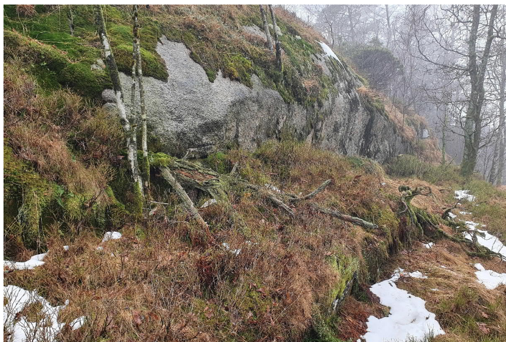
Figur 9: Massiv granitt, bildet er tatt ca. 50 m fra det østlige påhugget. Sprekkesett S1 og benkning med de subhorizontale sprekke.
