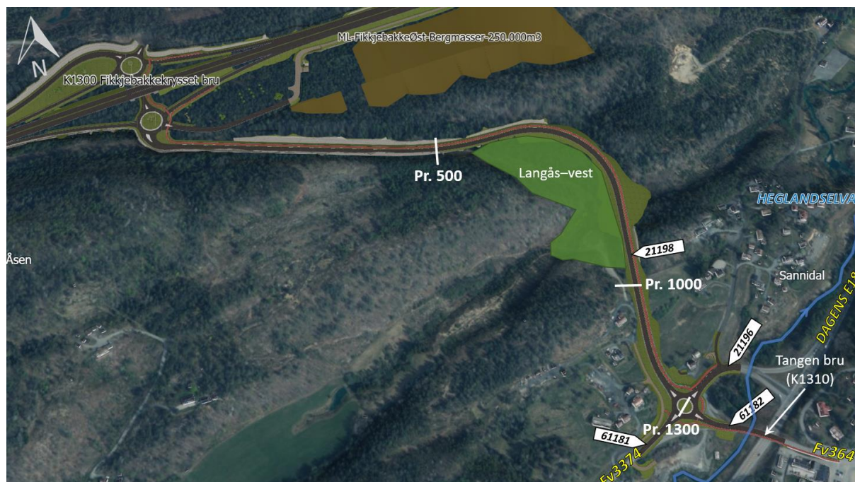
Figur 5-23 Illustrasjon av veimodell 21198 mellom pr. 0–1300. Deponi Langås-vest og Fikkjebakke-øst er vist henholdsvis i grønn og brun.
