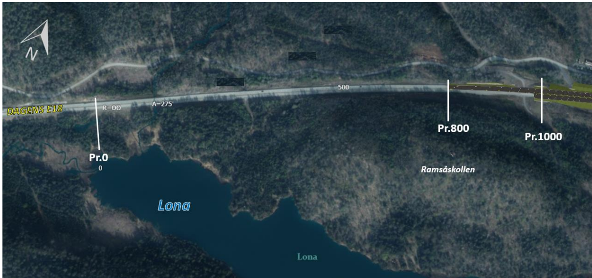
Figur 5-1 Illustrasjon av veimodell 10000 mellom pr.0–1000. Prosjektert E18 kobles på dagens E18 ved pr.800.
