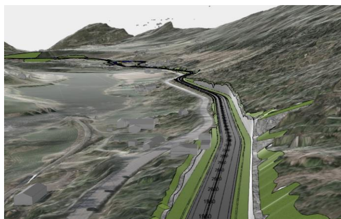
Figur 3-5: Illustrasjon av alternativ 1C fra Slåttlykkja mot nord. Ny E6 øst for dagens E6.
