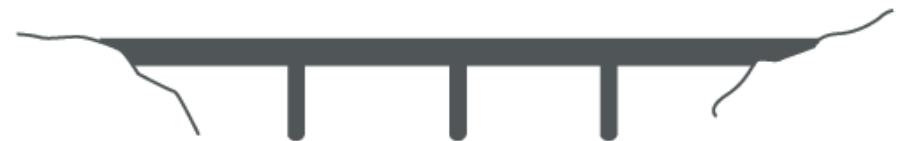
Prinsippskissen viser et eksempel på en bro som underordner seg landskapet. For at dette skal fungere godt er plassering i landskapet og terrengformingen tilknyttet til broen avgjørende.
