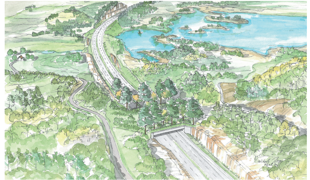
Lokk over E39 ved Blørstad. Beplantede voller skjærer mot vei og flatt parti sikrer passasje på midten. Terreget skråer slakt mot eksisterende på hver side av passasjen.
