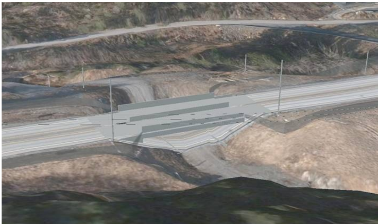
Figur 9 Kombinert viltpassasje og landbruksvei under dagens E18 ved Bråtane
