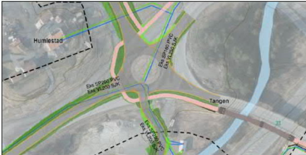
Figur 3-3: Eksisterende VA Sannidal.
