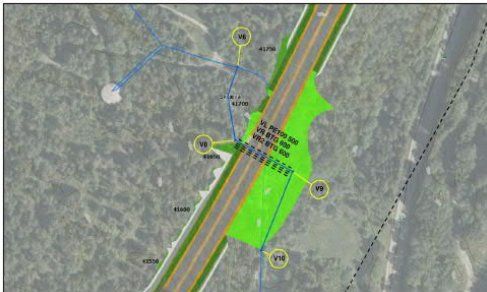
Figur 3-1: Omlagt vannledning (blå) og varerør (sort) ved Grøtvann
