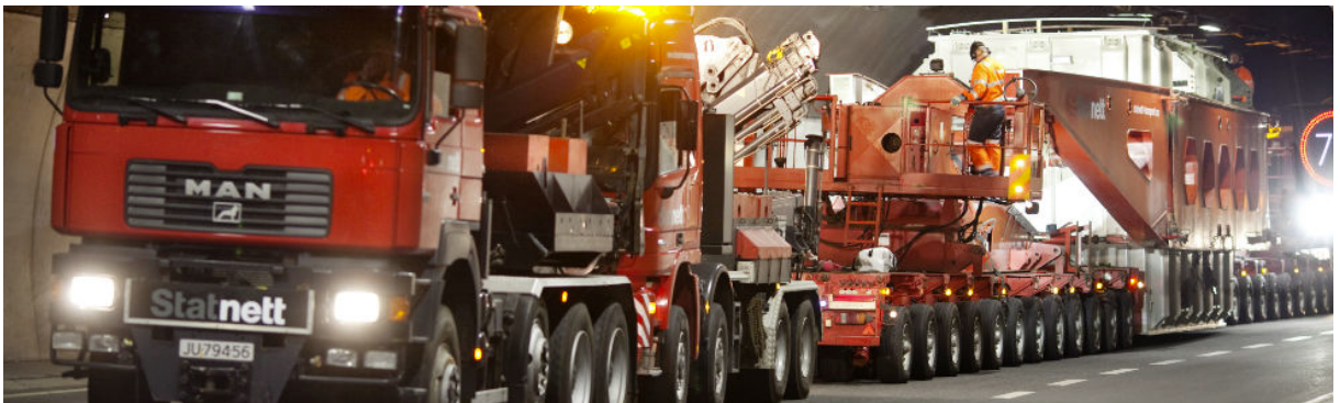
Bilde: Eksempel på spesialtransport av trafo.
