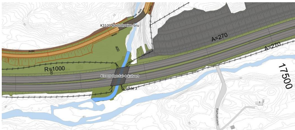
Figur 4-27: Dørdal 4 kulvert – faunapassasje under E18. Grasdaltjennbekken kommer ned fra nord og munner ut i Gongelva som renner vestover mot Bakkevann langs sørsiden av E18.
