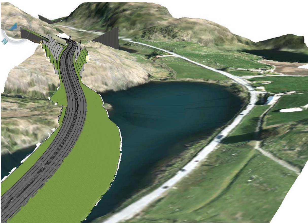
Figur 12 Forslag til veilinje der anlegget har blitt trukket lenger inn mot Holmafjellet og på nordsiden av Runatjørna. Veien går på fylling over Ytra Kydlandsvatnet.
