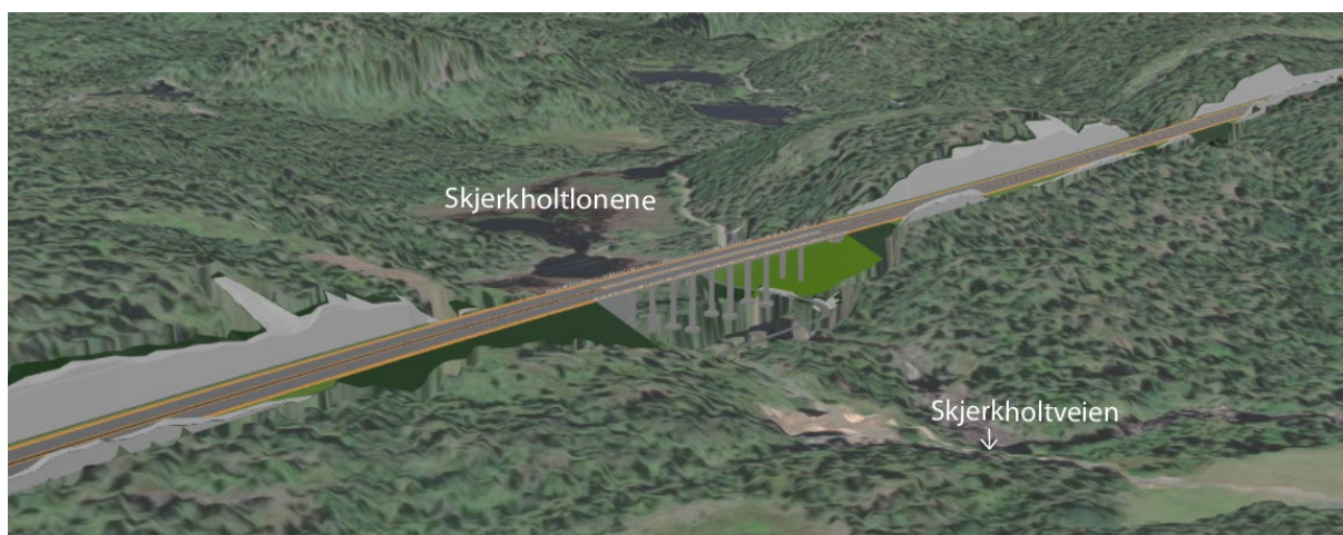
Figur 6-84: Ny veilinje på bru over Skjerkholtlonene, ferdsel langs Skjerkholtveien opprettholdes under. Sett fra sør mot nord.
