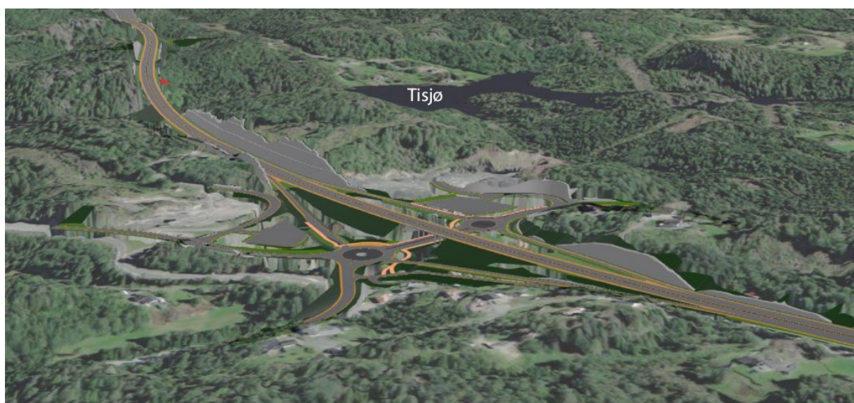
Figur 6-36: Nytt kryss ved Gjerdemyra, der Drangedalsveien krysser under ny E18 via to rundkjøringer. Sett fra sørvest mot nordøst.
