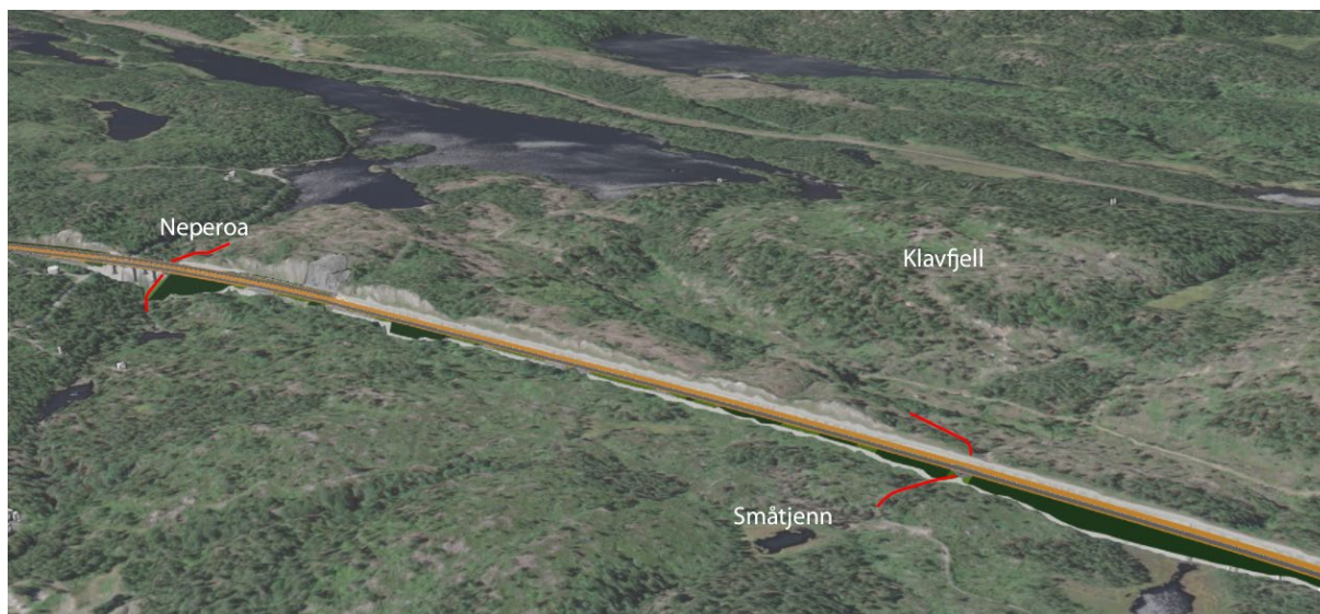
Figur 6-67: Ferdseisforbindelse på tvers av dagens E18 ved Småtjenn, markert med rødt, er planlagt opprettholdt under ny E18, via kulvert ved Småtjenn og under E18-bru ved Neperoa. Sett fra øst mot vest.
