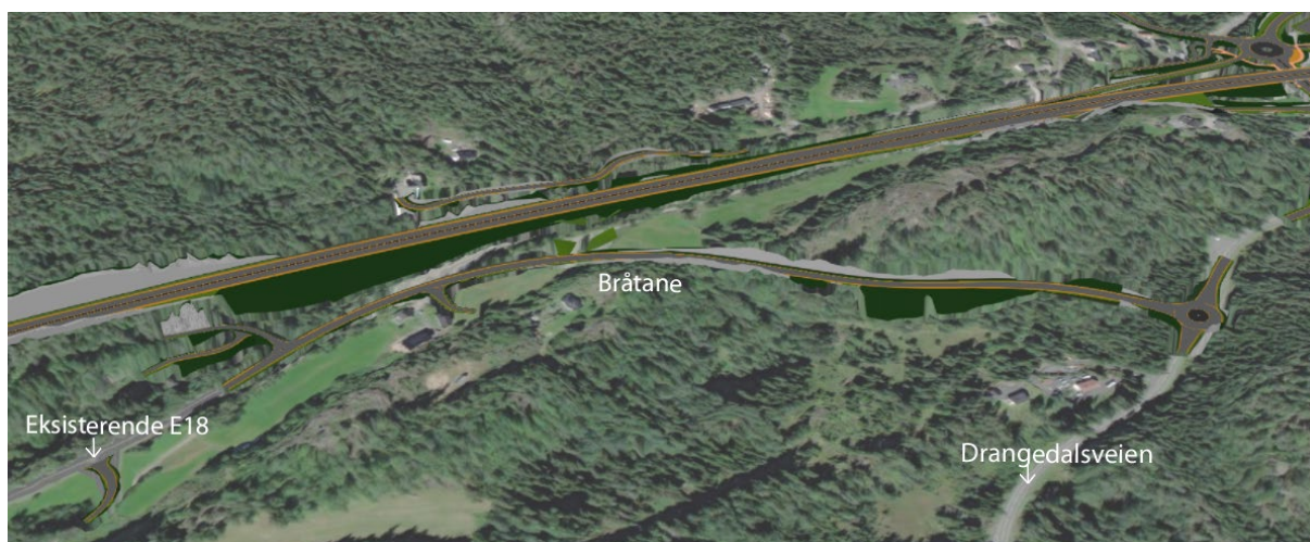
Figur 6-41: Eksisterende E18 vil forlenges og gi arealbeslag ved Bråtane. Sett fra øst mot vest.
