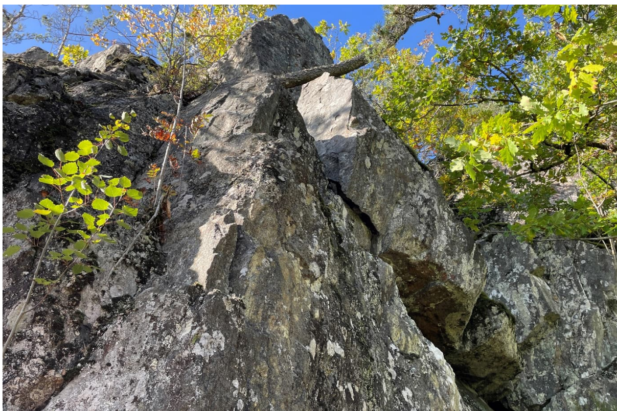
Figur 10-4: Avløste blokker ved ca. profil 11135-11140. Fotograf Ingvild Sangesland Qvist.
