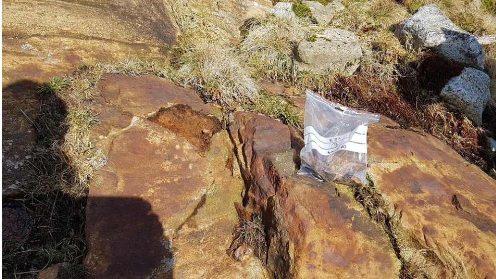
Figur 7: Forvitret overflate, mye biotitt i bergarten – mistanke om sulfider i bergarten pga. forvittringsfargene, prøve nr. 3.
