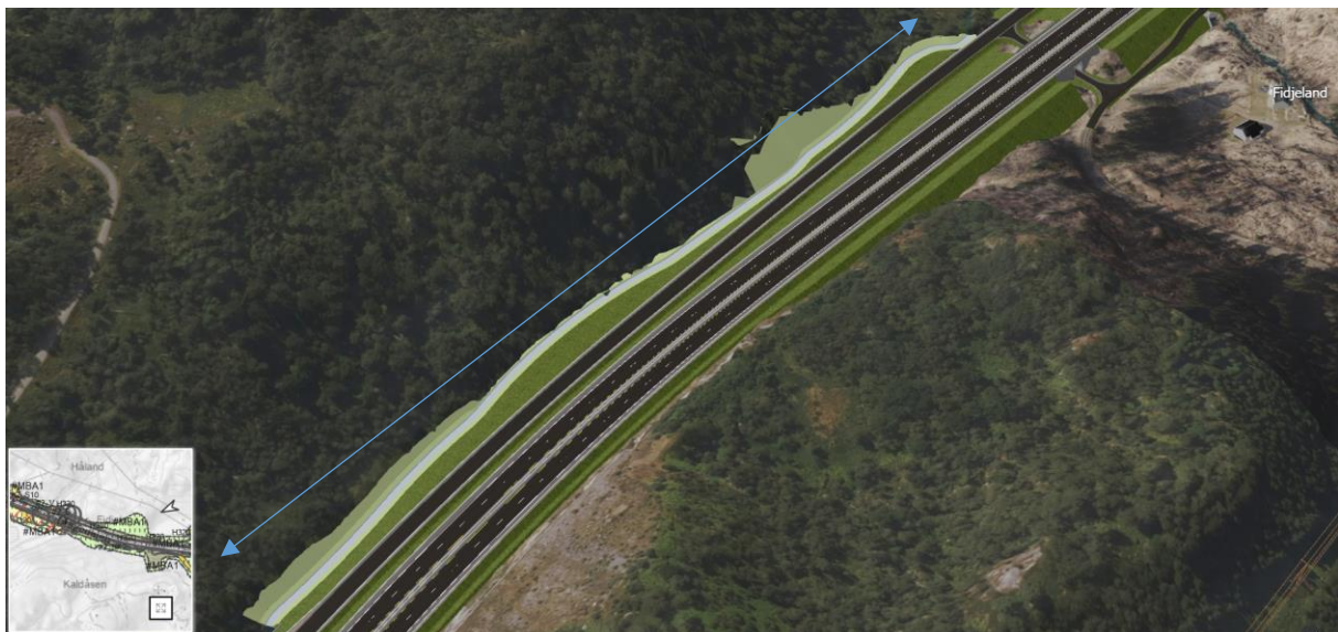
Figur 4-5: Omlegging av bekk fra Ytre Tjomslandsvann for strekning med veiprofil ca. 6150–6600. Utklipp fra 3D-innsynsløsning med synsvinkel mot sørvest.
