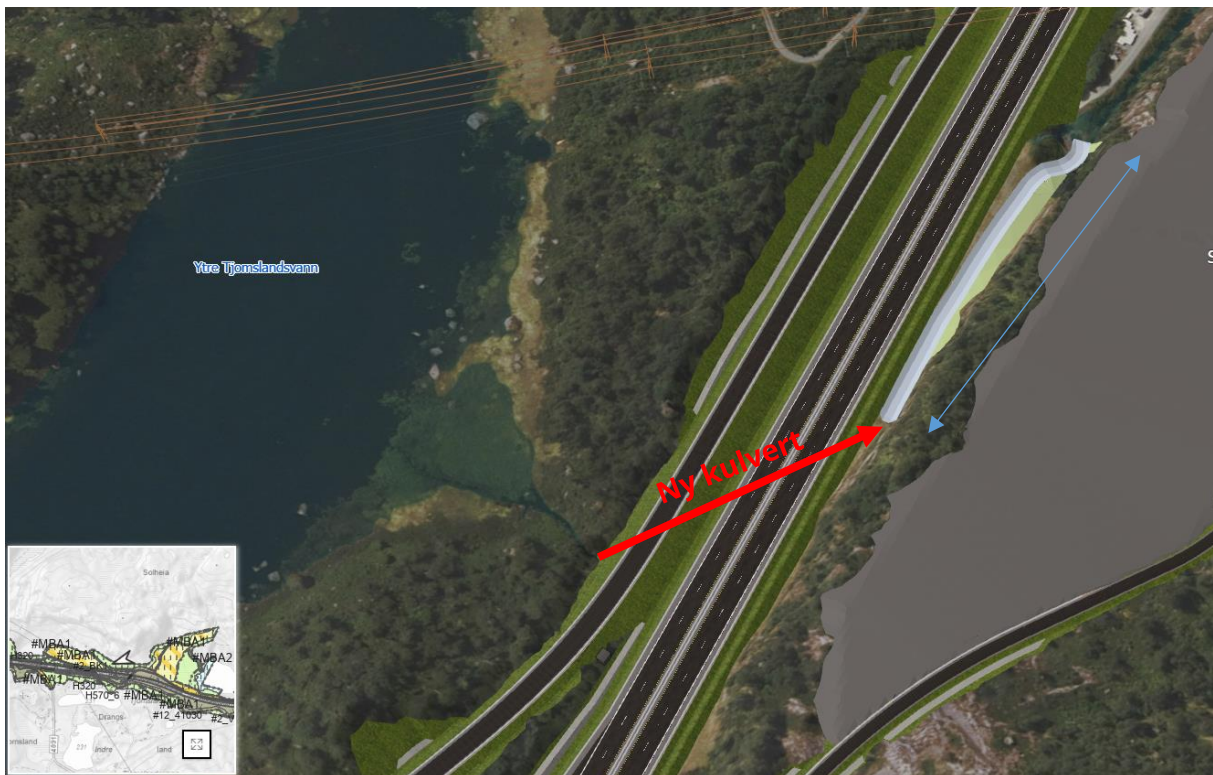
Figur 4-4: Omlegging av bekk fra Ytre Tjomslandsvann for strekning med veiprofil ca. 5550–5700. Utklipp fra 3D-innsynsløsning med synsvinkel mot sørvest.
