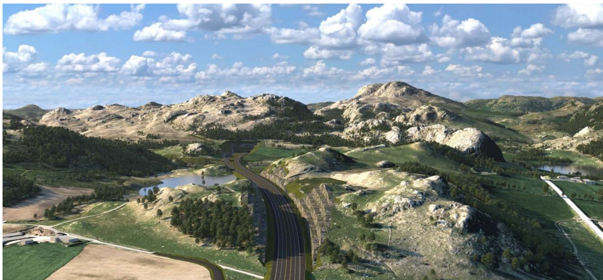
Figur 6-24: Illustrasjon av planlagt løsning for skjæring 8800. Skjæring 9200 og søndre påhugg sees i bakgrunnen.
