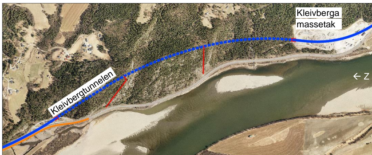
Figur 2-10 Oversiktskart Kleivbergtunnelen med foreslåtte rømnings tunneler/nødutganger (markert med røde streker)
