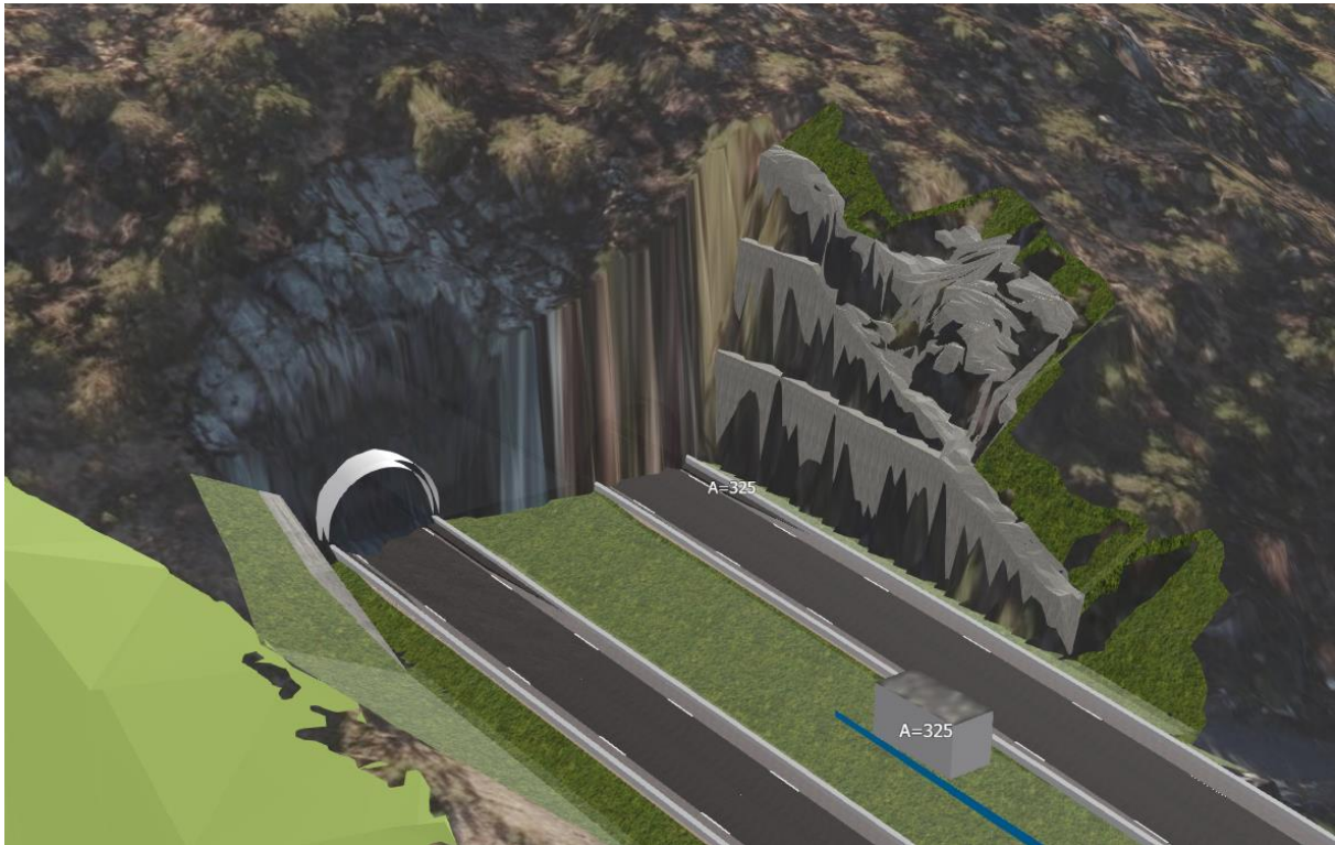
Figur 5-3: Modellutklipp fra Vatlandstunnelen påhugg sør. Til venstre i bildet er eksisterende løp. Nytt løp skal etableres på høyre side.
