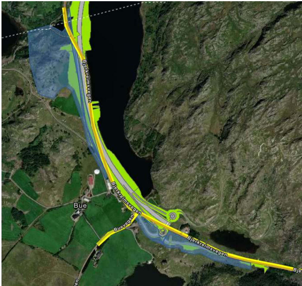
Figur 3-7: Mulig løsning for realisering av veianlegg ved Ytra Kydlandsvatnet og Buekrysset, fase 1. Blått er arbeidsområde og gult er trafikk.
