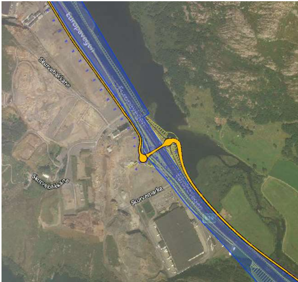
Figur 3-24: Skurve fase 2 - Gjennomgående trafikk på ny lokalvei, gjennom kryss og via Skurve marka. Etablere ny E39 og resten av kryssområde.
