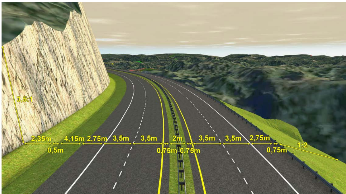
Figur 1-2: Tverrprofil veiklasse H3nv
