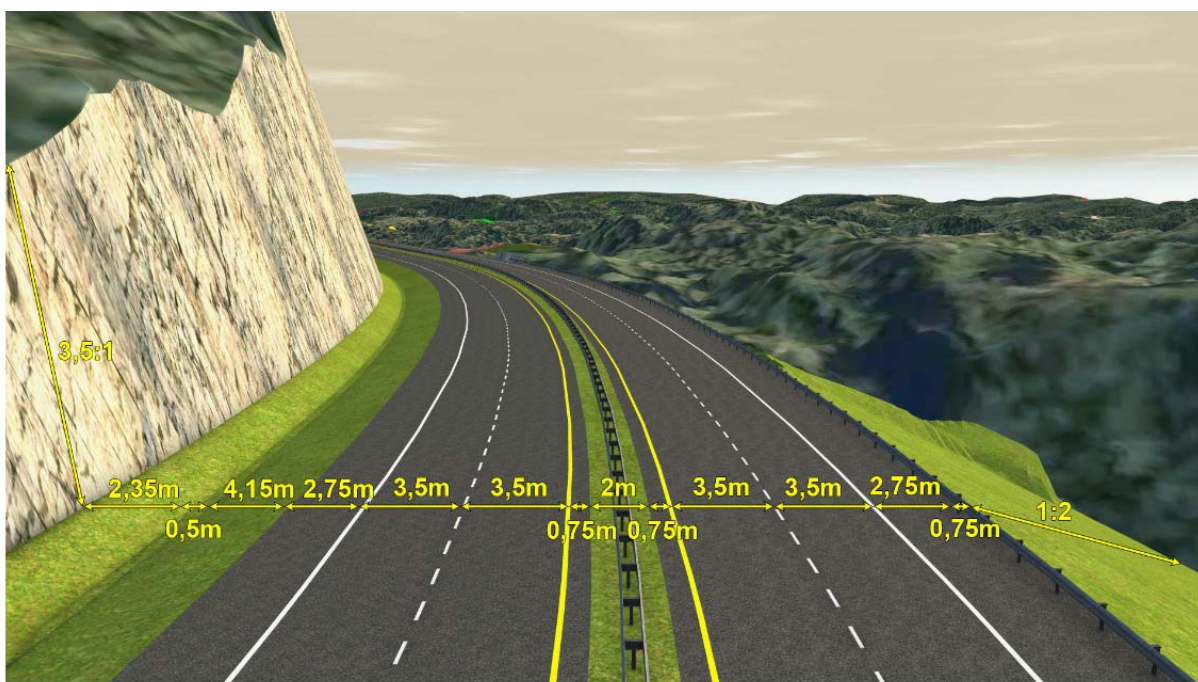
Figur 4. Tverrprofil veiklasse H3nv
