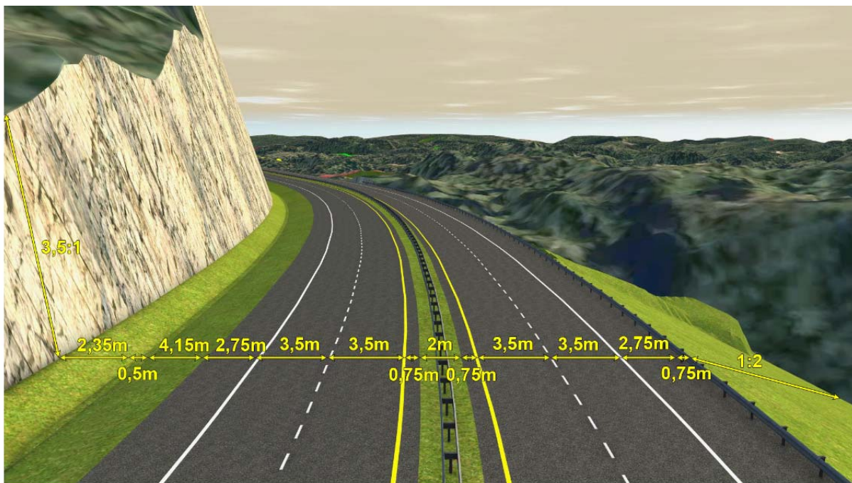
Figur 1-2 Tverrprofil veiklasse H3nv
