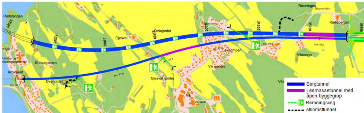
Figur 4-22 Oversikt over tunnelstrekningene mellom Rudsøgarden/Kroksund og Kjellerberget. Veg og bane danner en felles trasé fra Viksenga og vestover. Vegtunnelene er øverst i illustrasjonen.
