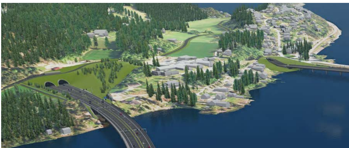
Figur 4-10 Illustrasjon av vegbru over Kroksund og dagsone mellom Pilevika og Rudsøgarden, sett fra Kroksund. Hole bo- og rehabiliteringssenter sentralt i bildet. E16 senkes ned i terrenget og går inn i tunnel ved Rudsøgarden. I bakgrunnen ny lokalveg til Paddevika og portalområde for jernbanetunnel mellom Kroksund og Kjellerberget.
