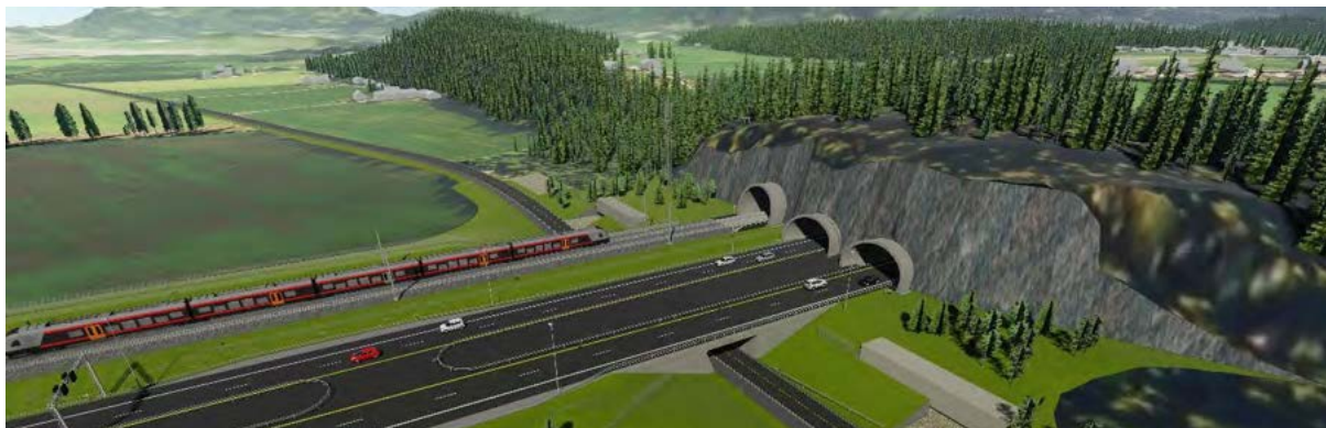
Figur 4-26 Illustrasjon av kryssing av Selteveien. Selteveien er flyttet ut fra Kjellerberget og lagt under ny E16 og bane. Traséen for E16 og bane ligger på fylling ut på Bymoen ved Hvitmyr. Tunnelportaler ved Kjellerberget til høyre.
