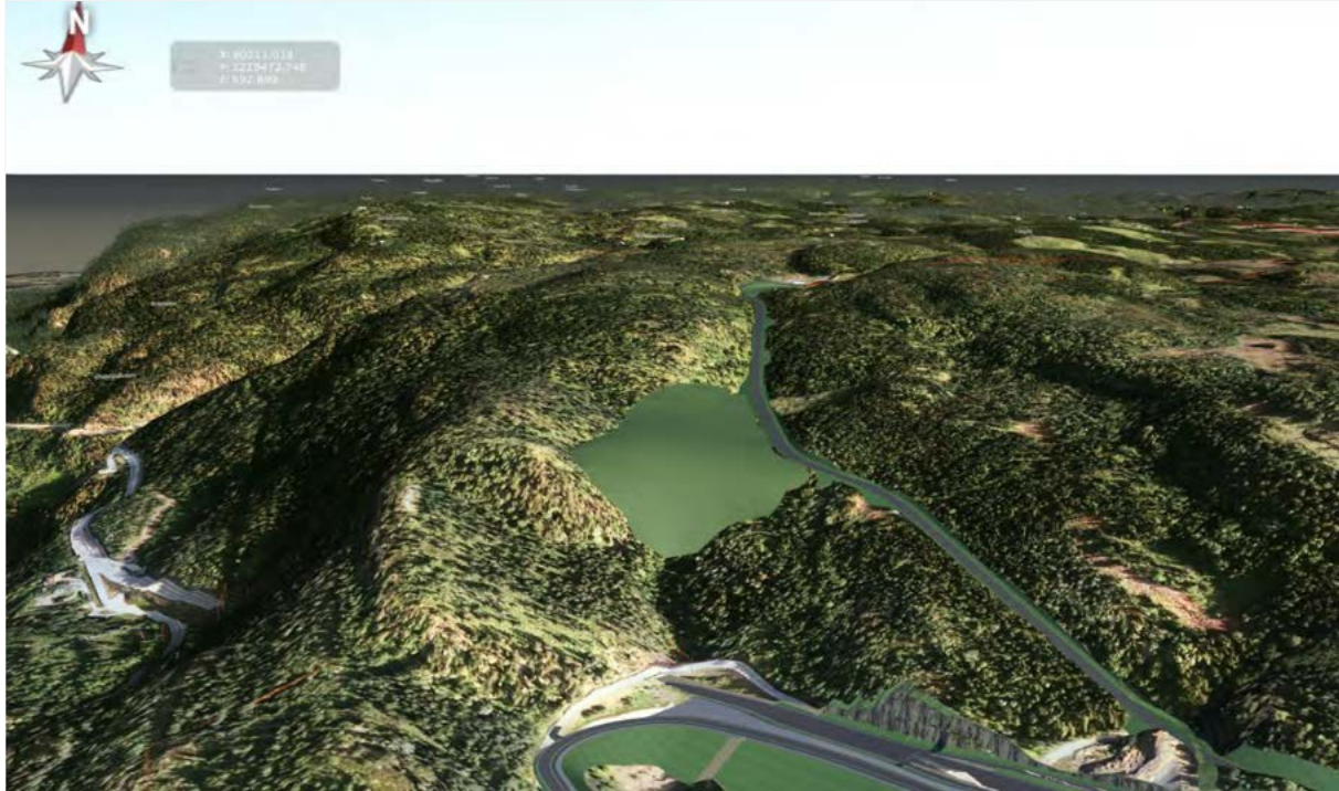
Figur 4-6 Illustrasjon av mulig utforming av masselager Nordlandsdalen. Illustrert fylling innebærer oppfylling av terrenget på ca. 20 meter på det høyeste og ca. 850 000 m 3 lagrede masser. Området får atkomst via skogsveg i Nordlandsdalen, som oppgraderes i forbindelse med anleggsgjennomføring. I forgrunnen sees planlagt ny E16 Bjørum-Skaret.
