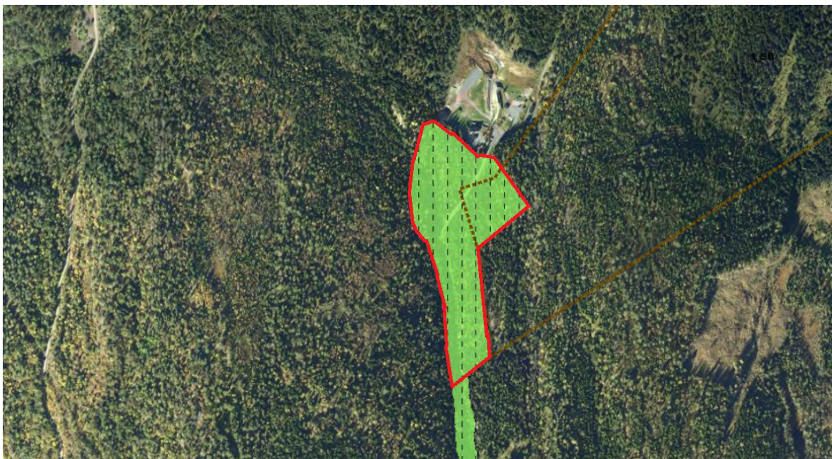
Figur 4-53 Illustrasjon av midlertidig atkomsttunnel og riggområde ved Høgås. Skytebanen ved Høgås øverst i bildet. Avgrensning av riggområdet er vist med rødt omriss. Reguleringsplanens formålsflater vist i bakgrunnen.
