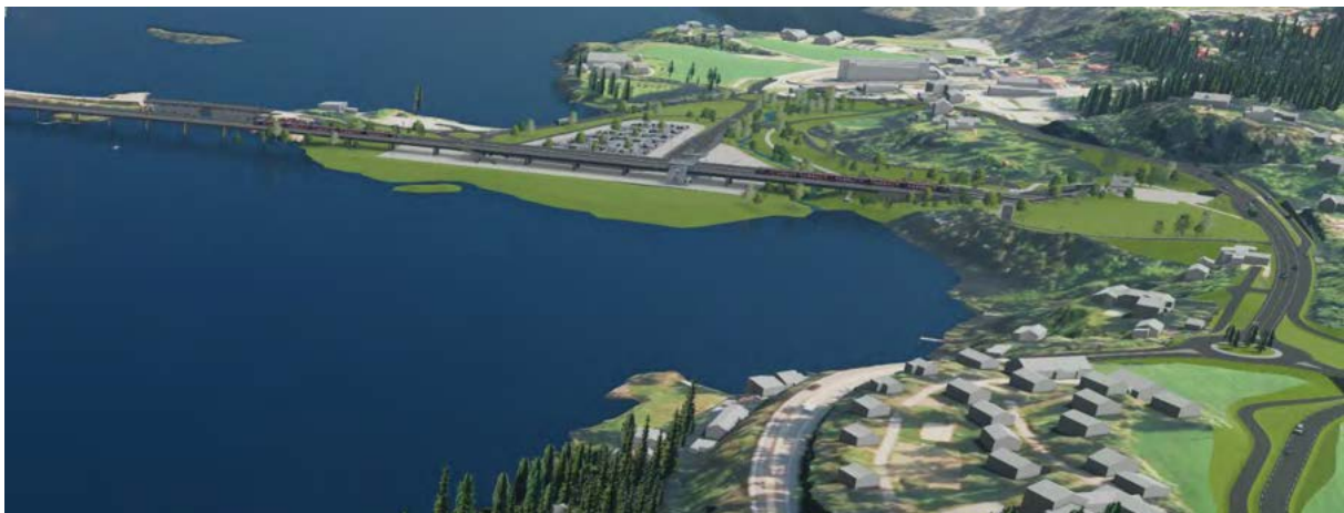
Figur 4-14 Illustrasjon av utfyllingsomfang i planalternativ Sundvollen A. Utfyllingen omfatter utfylling for etablering av stasjon og kollektivt knutepunkt, med landskapstilpasset fyllingsfront utenfor stasjonen mot Tyrifjorden.
