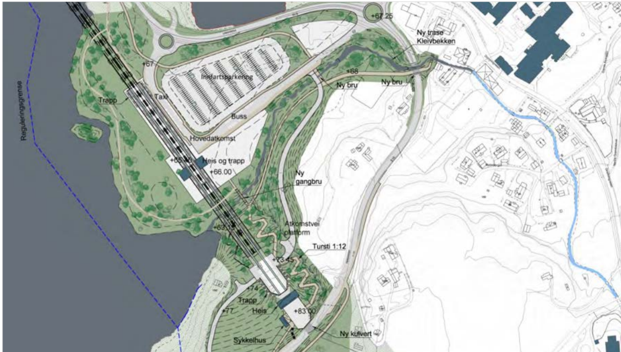
Figur 4-18 Illustrasjonsplan for mulig utforming av kollektivknutepunkt, atkomster til Sundvollen stasjon og omlegging av Kleivbekken. Det planlegges nye rundkjøringer i Holeveien for atkomst til stasjon. Planalternativ Sundvollen A.
