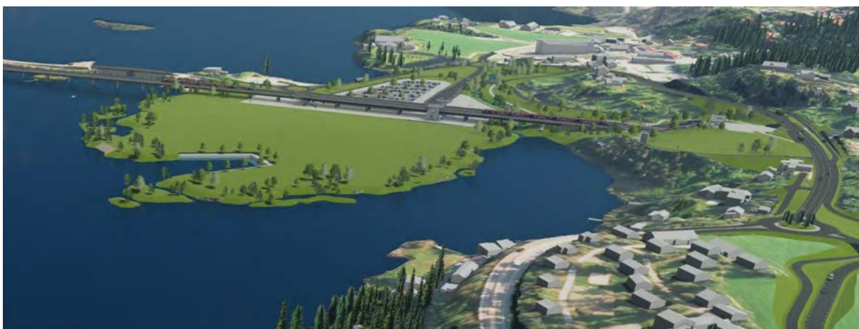
Figur 4-15 Illustrasjon av utfyllingsomfang i planalternativ Sundvollen B. Utfyllingen omfatter utfylling for etablering av stasjon og kollektivt knutepunkt, samt tilrettelegging for tettstedsutvikling på fylling utenfor stasjonen mot Tyrifjorden.
