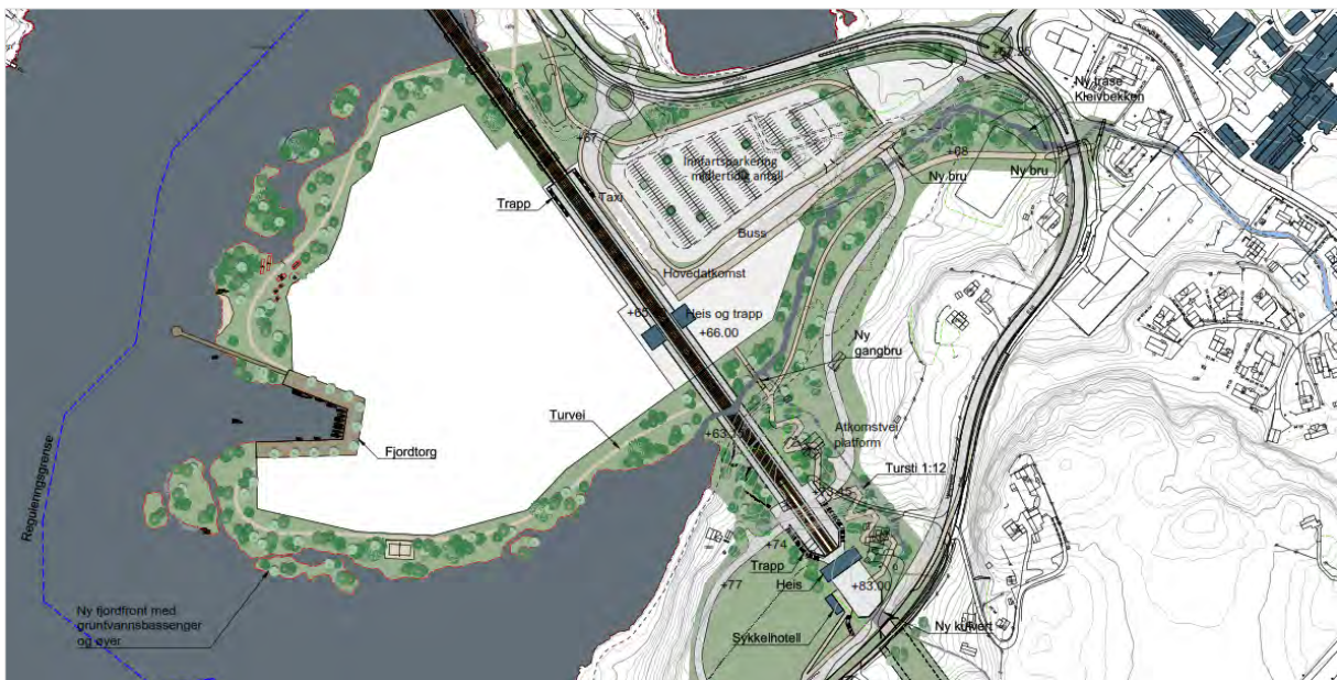
Figur 4-19 Illustrasjonsplan for mulig utforming av kollektivknutepunkt, atkomster til Sundvollen stasjon og omlegging av Kleivbekken. Det planlegges nye rundkjøringer i Holeveien for atkomst til stasjon. Planalternativ Sundvollen B.
