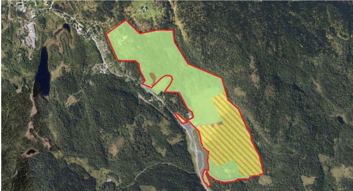
Figur 4-52 Illustrasjon av riggområder og områder for permanent lagring og bearbeiding av masser ved Avtjerna. Avgrensning av riggområdet er vist med rødt omriss. Reguleringsplanens formålsflater vist i bakgrunnen. Det samlede området er på ca. 770 dekar. E16 mot Sollihøgda går vest for området.
