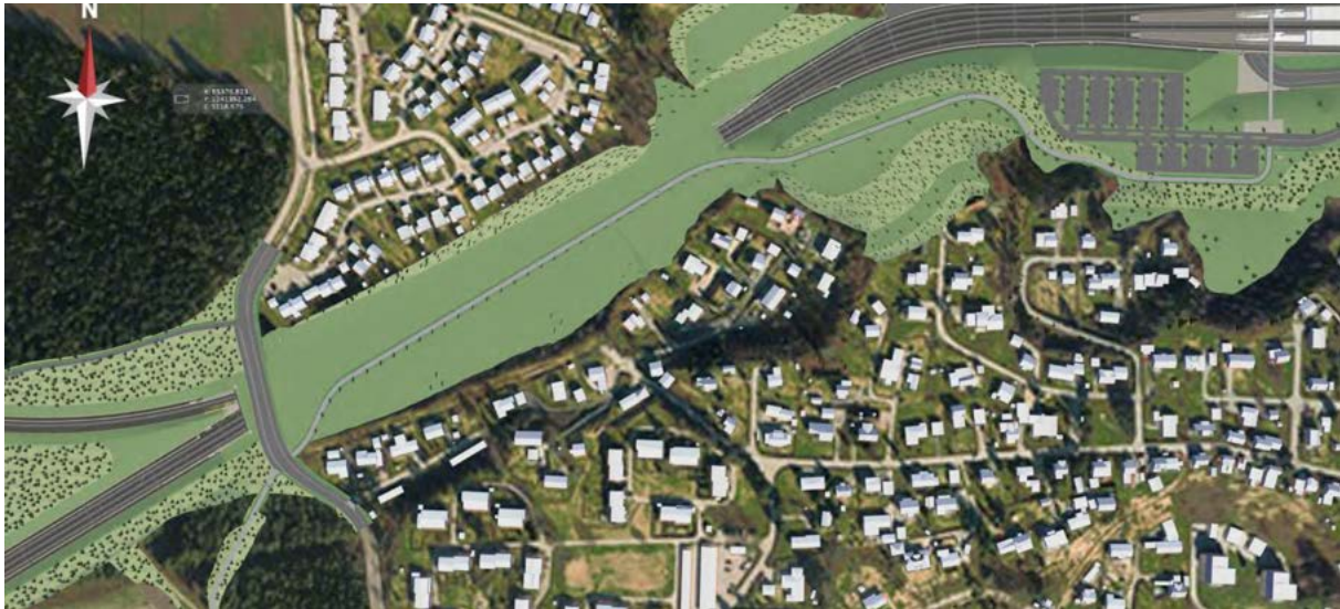
Figur 4-42 Illustrasjon av togkulvert gjennom Storskjæringa. Ringveien krysser over kulverten i vest. Parkering ved Hønefoss stasjon i øst. Det planlegges gangveg mellom stasjonsområdet og Ringveien.
