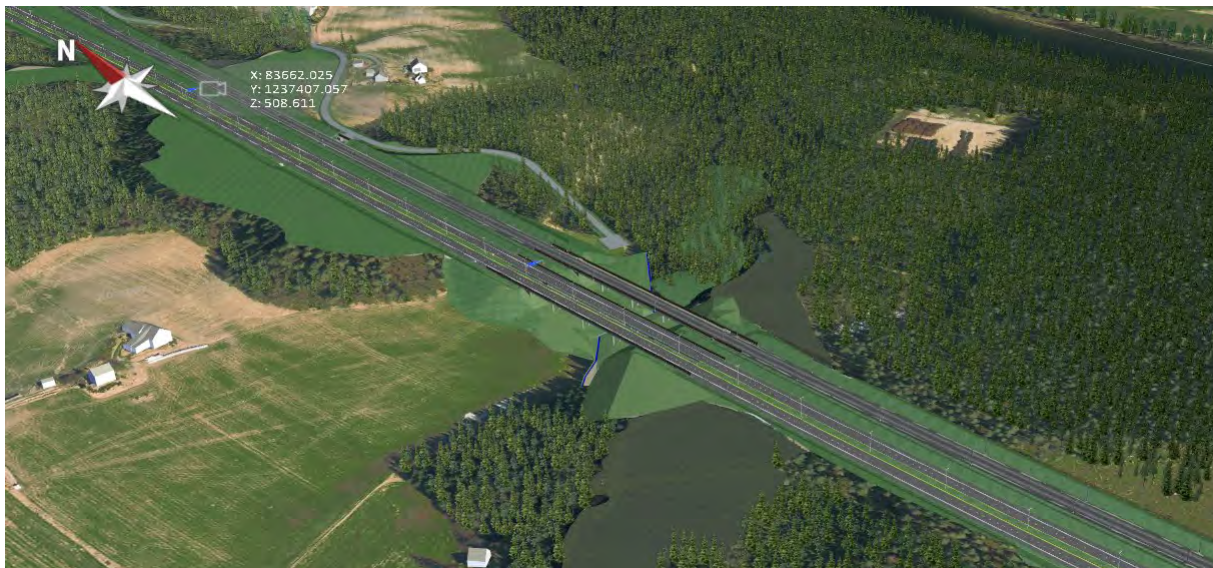
Figur 4-38 Bruer i linja over Korsdalen. Bebyggelse ved Dal i bakgrunnen. Bruene fungerer som en faunapassasje hvor vilt kan passere under. Oppe til venstre i bildet vises løsmasseskjæringer med slake skråninger for å ivareta grunnstabilitet.
