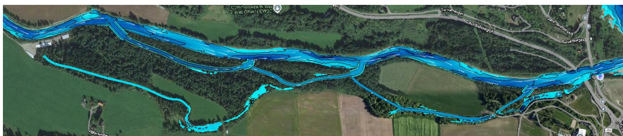
Figur 5-6. Simulering av åpning av flomvoll i en situasjon med lavvann (40 m 3 /s) i Gausa.
