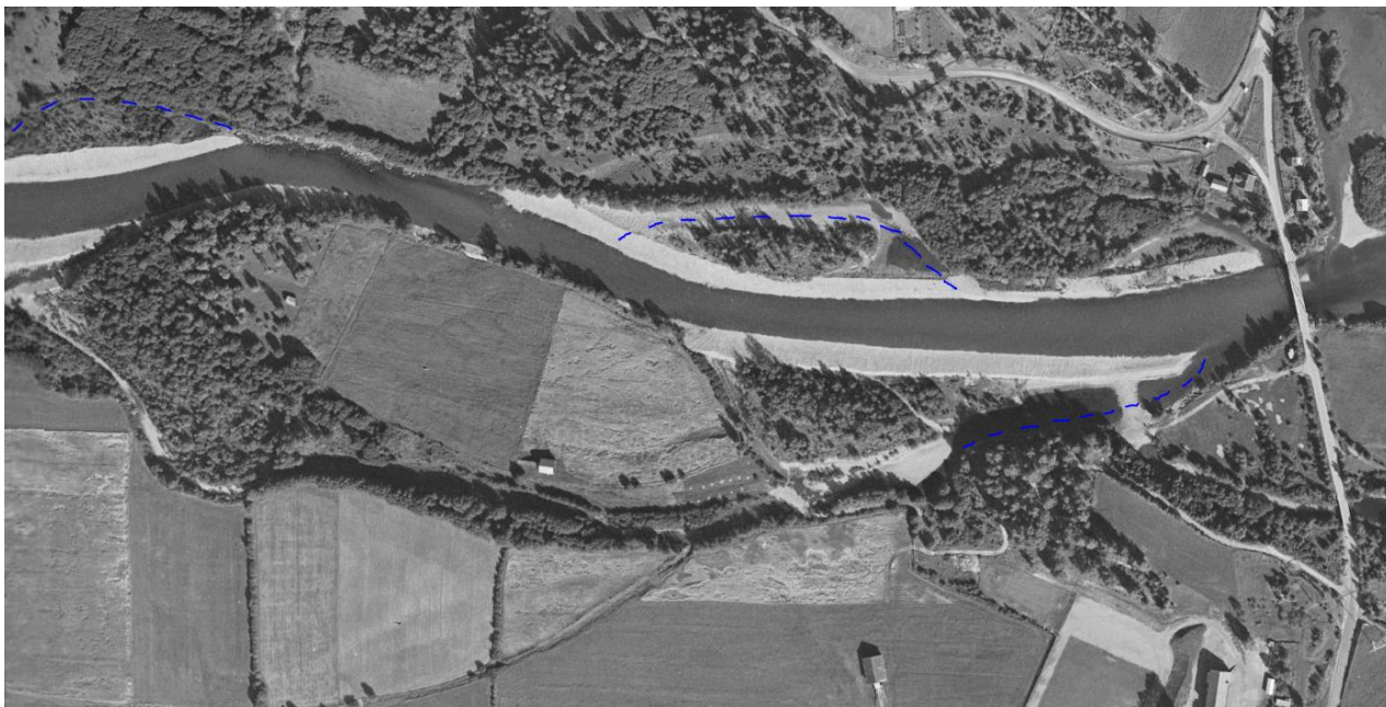
Figur 6-2. Kanaliseringen i nedre deler avskar et flomløp på nordsiden av Gausa og omkalfatret hele det gamle elvemøtet mellom Gausa og Veslegausa. På høye vannføringer går det fremdeles vann i flomløpet på nordsiden.
