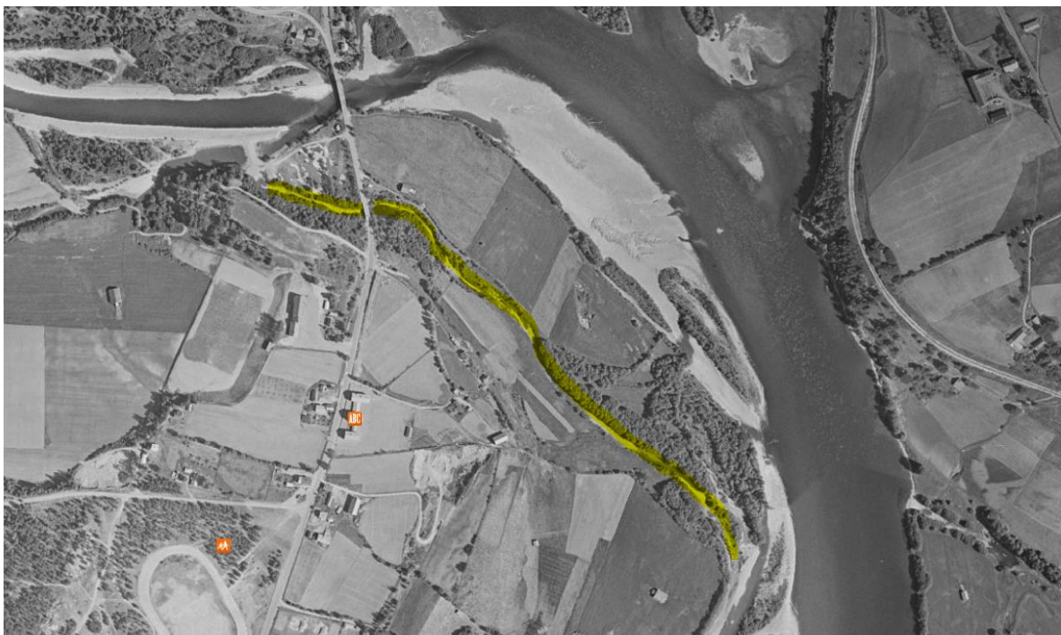
Figur 6-7. Kanaliseringen av Gausa medførte at innløpet til Veslegausa ble delvis avskåret. Samtidig senket trolig elvebunnen i Gausa seg slik at løpet inn i Veslegausa ble «hengende».
