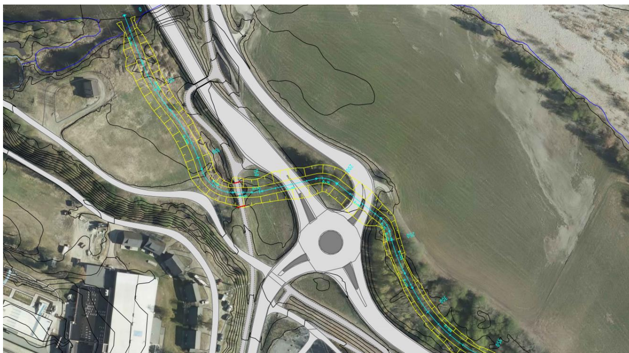
Figur 6-9. Det ble i forbindelse med rapporten " Utredning av ytterligere miljøforbedrende tiltak ved Lågendeltaet naturreservat» gjort vurderinger av løsninger der flomløpet for Veslegausa legges i kulvert under rundkjøringens nordre og østre arm, med føring av elva i nytt elveløp frem til det opprinnelige løpet langs Bronsøya.
