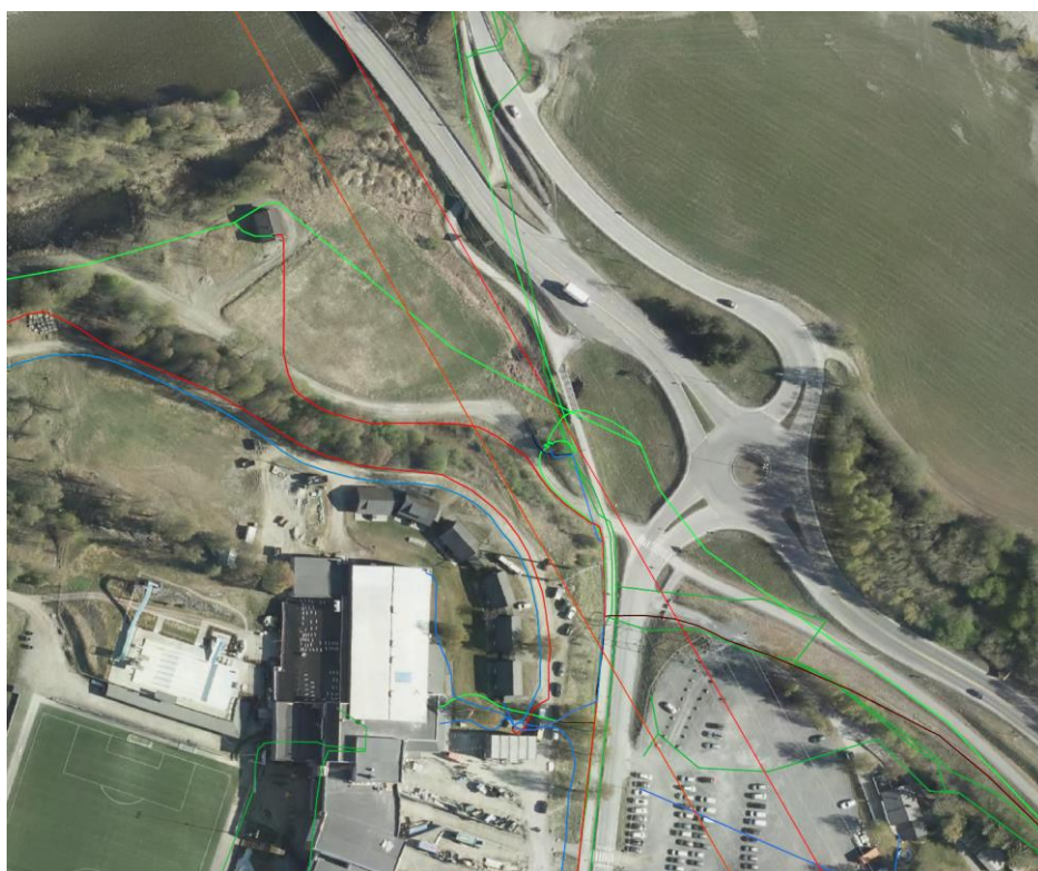
Figur 6-18. Eksisterende kabler og ledninger.
