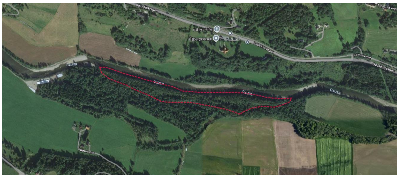
Figur 5-8. Flomvollen fjernes i markert område og legges ut igjen i Gausa slik at det opprinnelige elveprofillet gjenoprettes.
