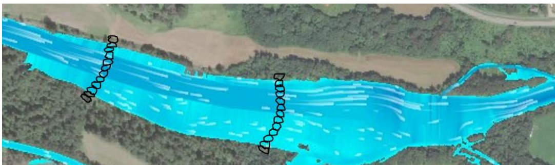
Figur 5-10. Det vil trolig være nødvendig å etablere noen terskler av grov stein på strekningen som kan bidra til å holde tilbake naturlige sedimenter og massene som flyttes tilbake i elva fra fløtningsvollene.
