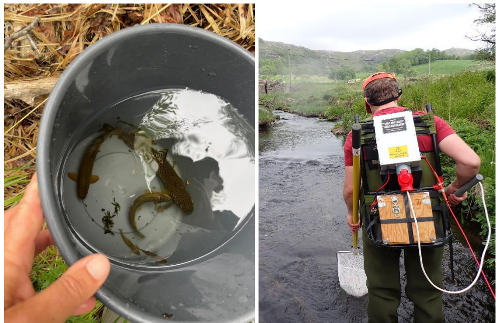
Figur 4-22. Til venstre; eksempel på fangst av fisk under ungfiskundersøkelsene. Til høyre; Paulsen elfiske-apparat.
