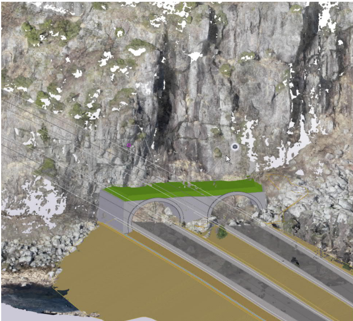
Figur 28: Utklipp fra 3d-modell som viser østlig påhuggsområde med prosjektert tunnel plassert omtrentlig som prosjektert.
