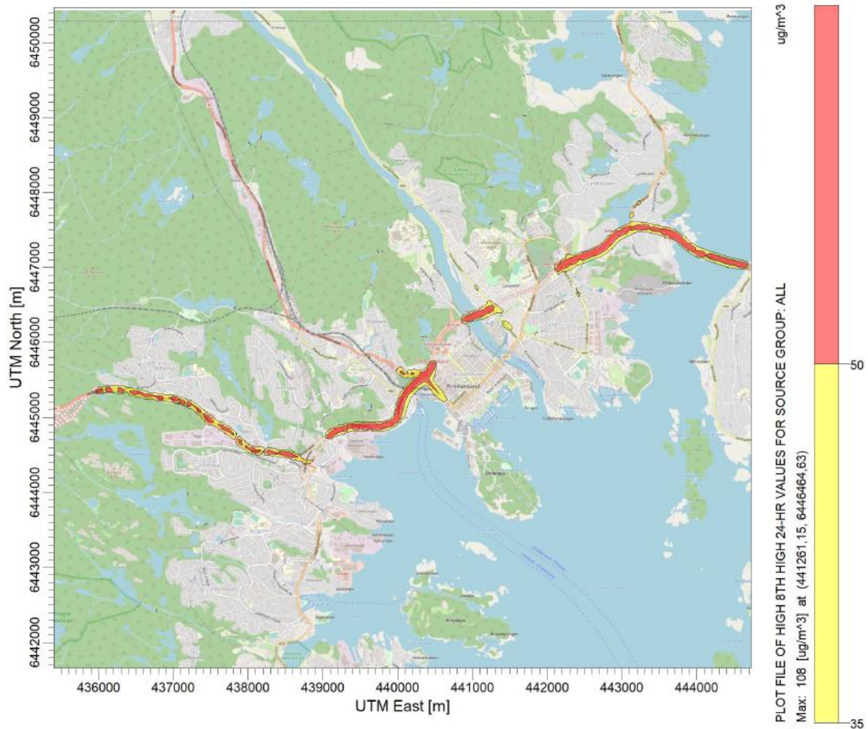
Figur 5-5: Modellert 8. høyeste døgnmiddelkonsentrasjon av PM 10 for E39/E18 mellom Vige og Grauthelleren, med fremskrevet trafikk for 2050. Store deler av veistrekningen ligger i rød sone.
