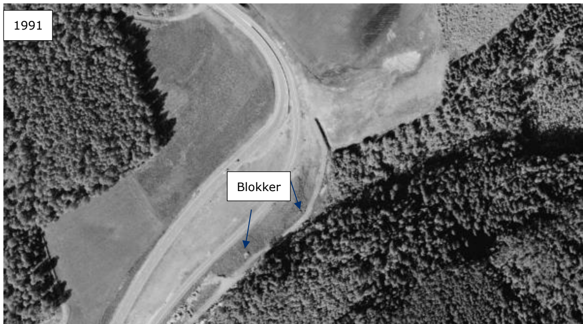
Figur 32. Bilde fra 1984 viser forholdene før veg ble bygd. Skråningen og foten er dekket av skog. Bilde fra 1991 viser to antatte steinsprangblokker. 1 kan ha vært utløst fra bergskjæringen, men 2 anses som utløst fra naturlig terreng.
