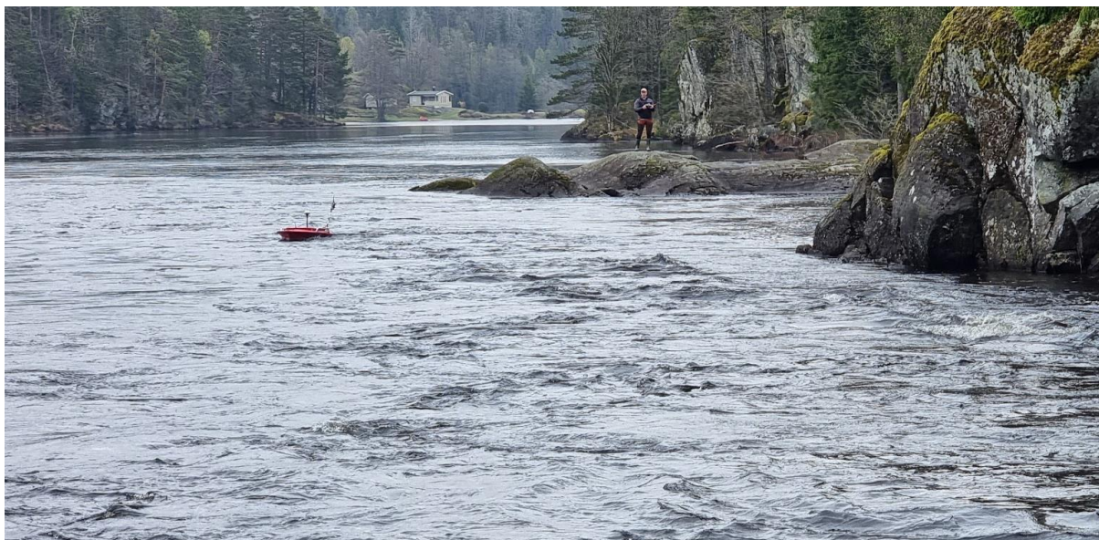
Figur 6-12 Dybdekartlegging i Tisjø med ADCP.
