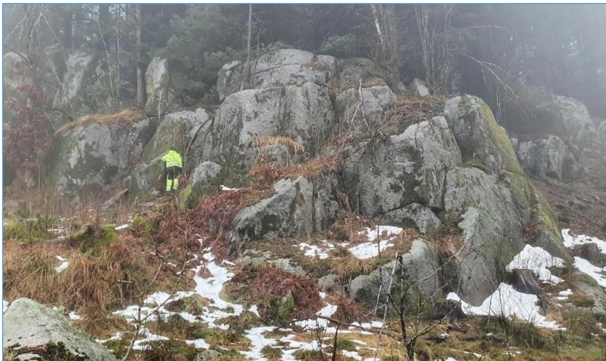
Figur 23: Bergmassen i området er massiv, har sprekker med stor utholdenhet og er noe avrundet som et resultat av isskuring.
