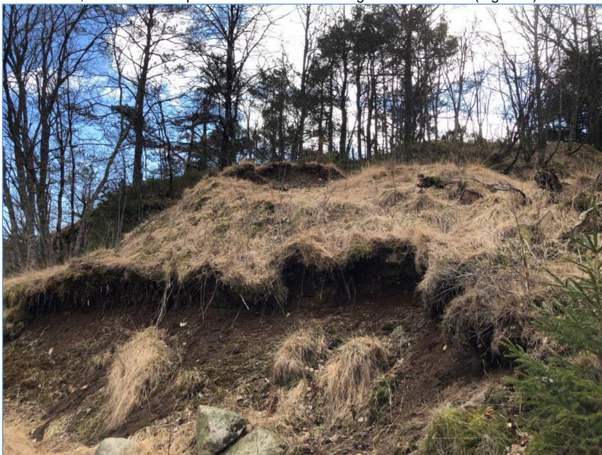
Figur 42: Løsmasselomme langs eksisterende skogsbilvei. Omtrent 2 m tykkelse.
