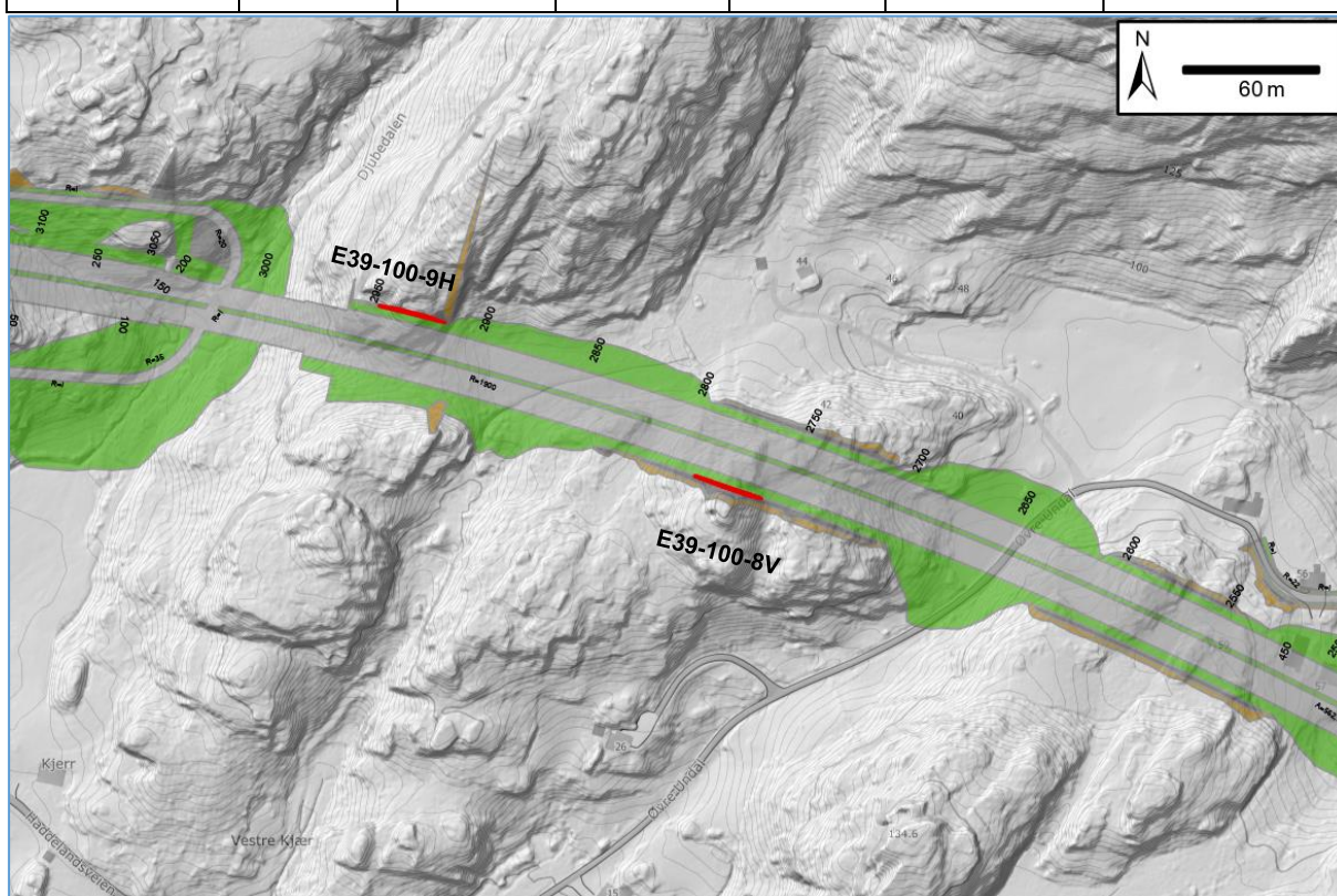
Figur 15: Oversikt over bergskjæringene med høyde over 10 m mellom Nedre Undal og Djubedalen.
