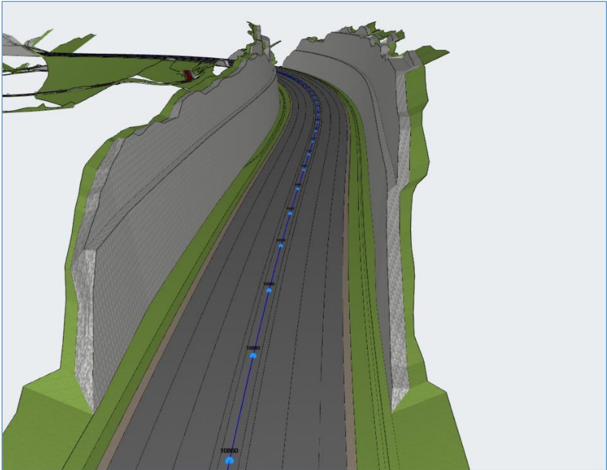
Figur 49: Utklipp fra modell som viser omfanget på skjæringene. Sett mot NNV.
