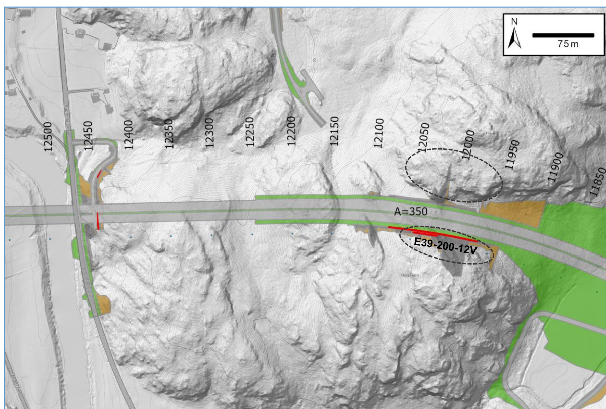
Figur 59: Områder som det er aktuelt å sikre over skjæringstoppene (stiplet).
