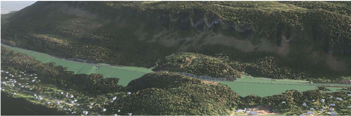
Figur 51 Terrengforming nord og sør for Hvalpåsen demper de visuelle virkningene av veganlegget
