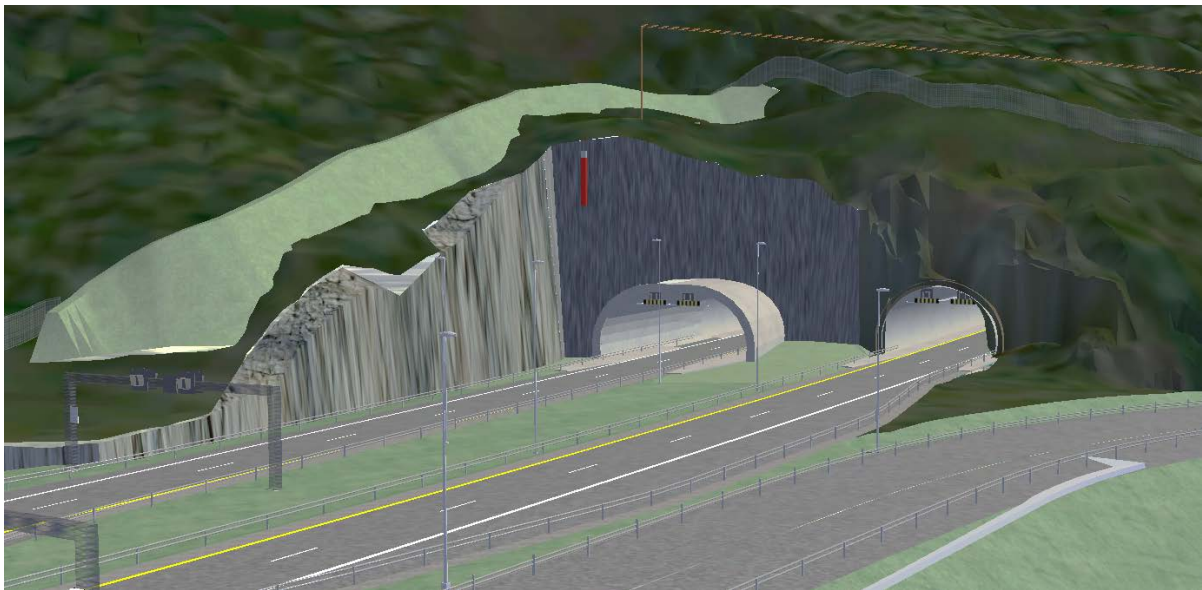
Figur 26 Portalområdet for Homledaltunnelen nord, eksisterende tunnel til høyere
